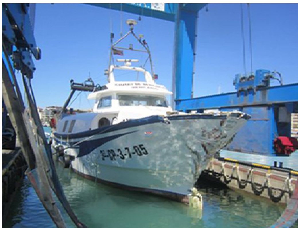
Figure 8 – CIUTAT DE BENICARLO Damages on forward end
