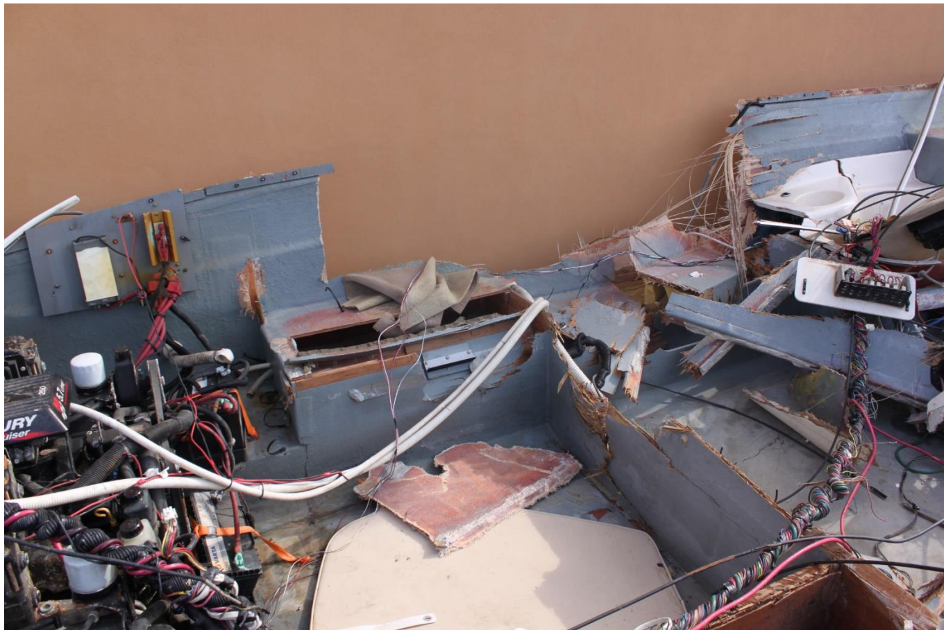
Figura 14. Vista de estribor hacia babor. Instalaciones arrastradas por la violencia del abordaje.
