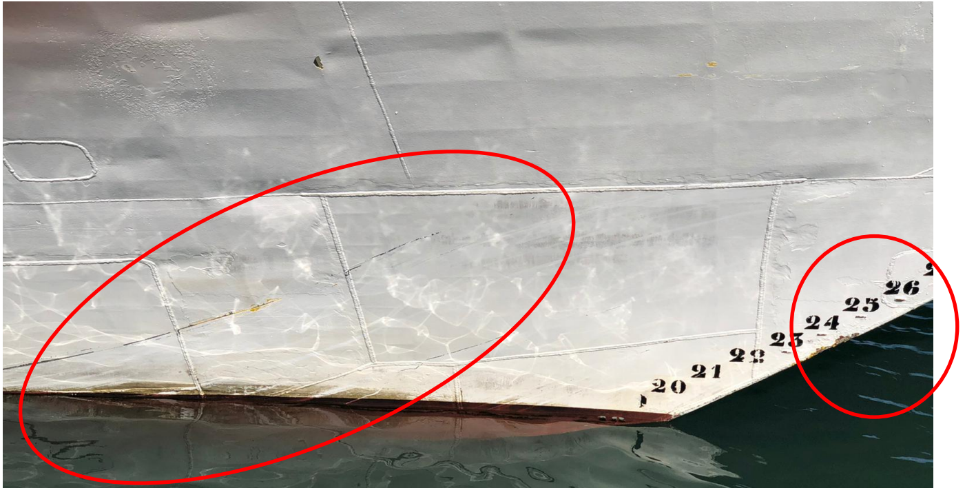
Figura 16. Marcas en el patín de estribor de la NSD FORMENTERA DIRECT.
