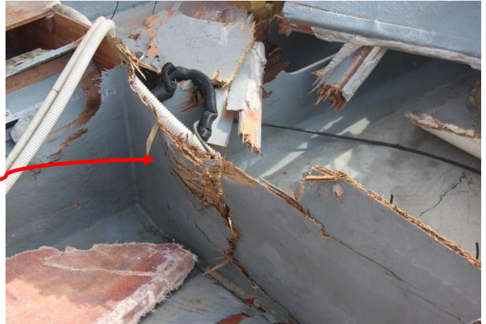
Mamparo transversal doblado, de madera, fibras rotas hacia proa y babor.
