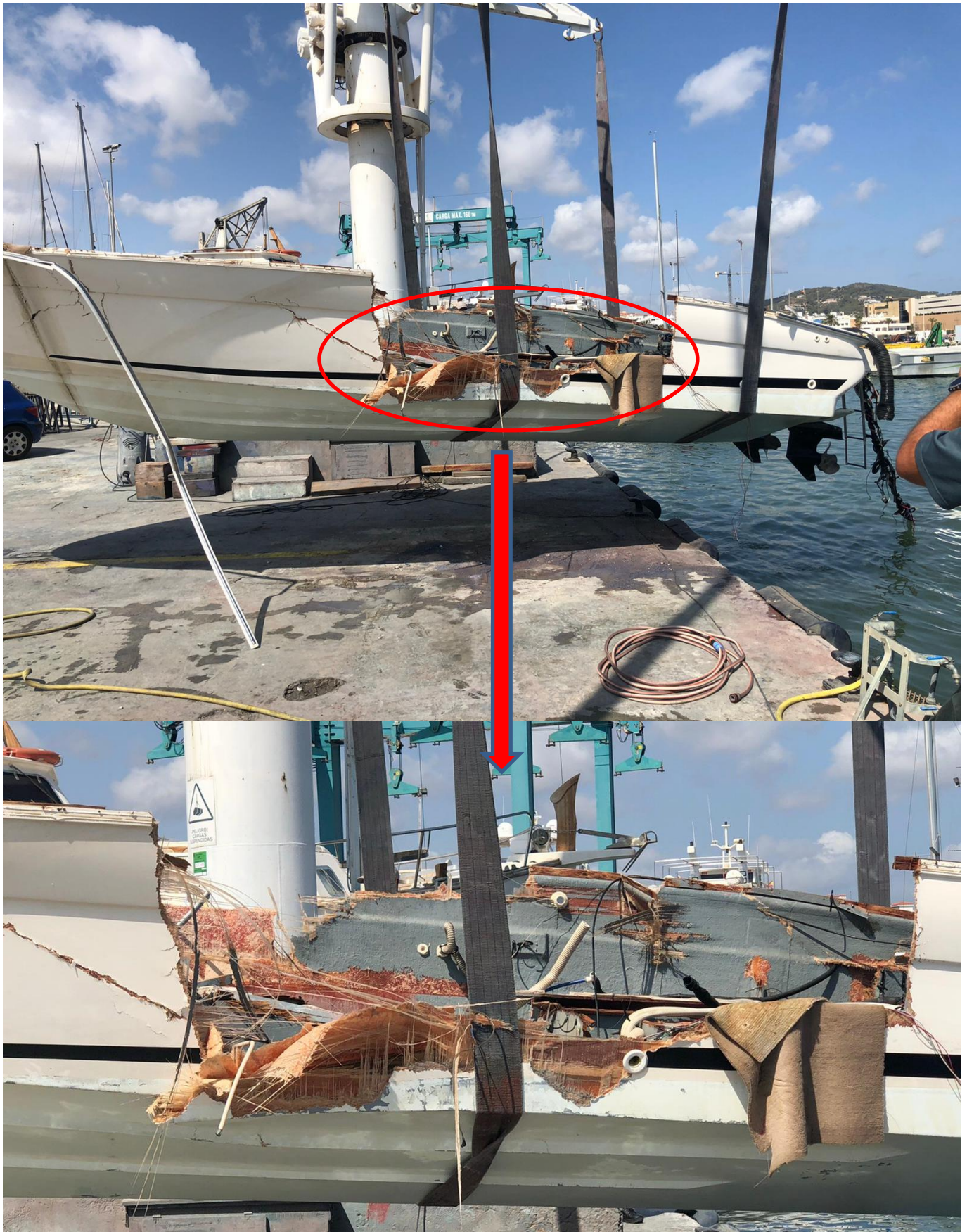
Figura 13. Banda de babor de la embarcación INDIA y detalle. Puede apreciarse como la fibra quedó destruida desde dentro.
