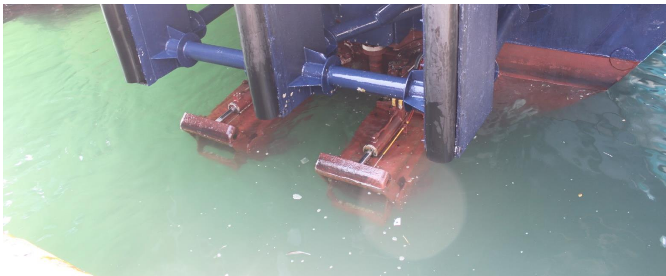
Figura 18. Toberas del patín de estribor del sistema de propulsión de la NSD FORMENTERA DIRECT, situadas más hacia la diametral del buque
