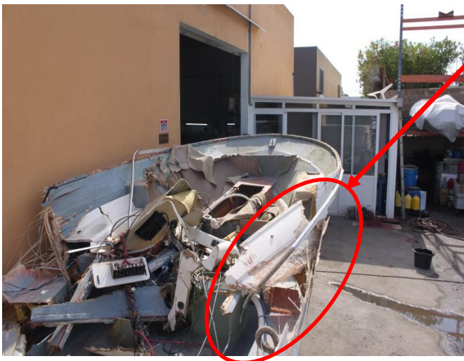
Casco doblado hacia babor. Se ha valorado y descartado que las labores de reflotado hubieran influido en la configuración de los restos analizados.
