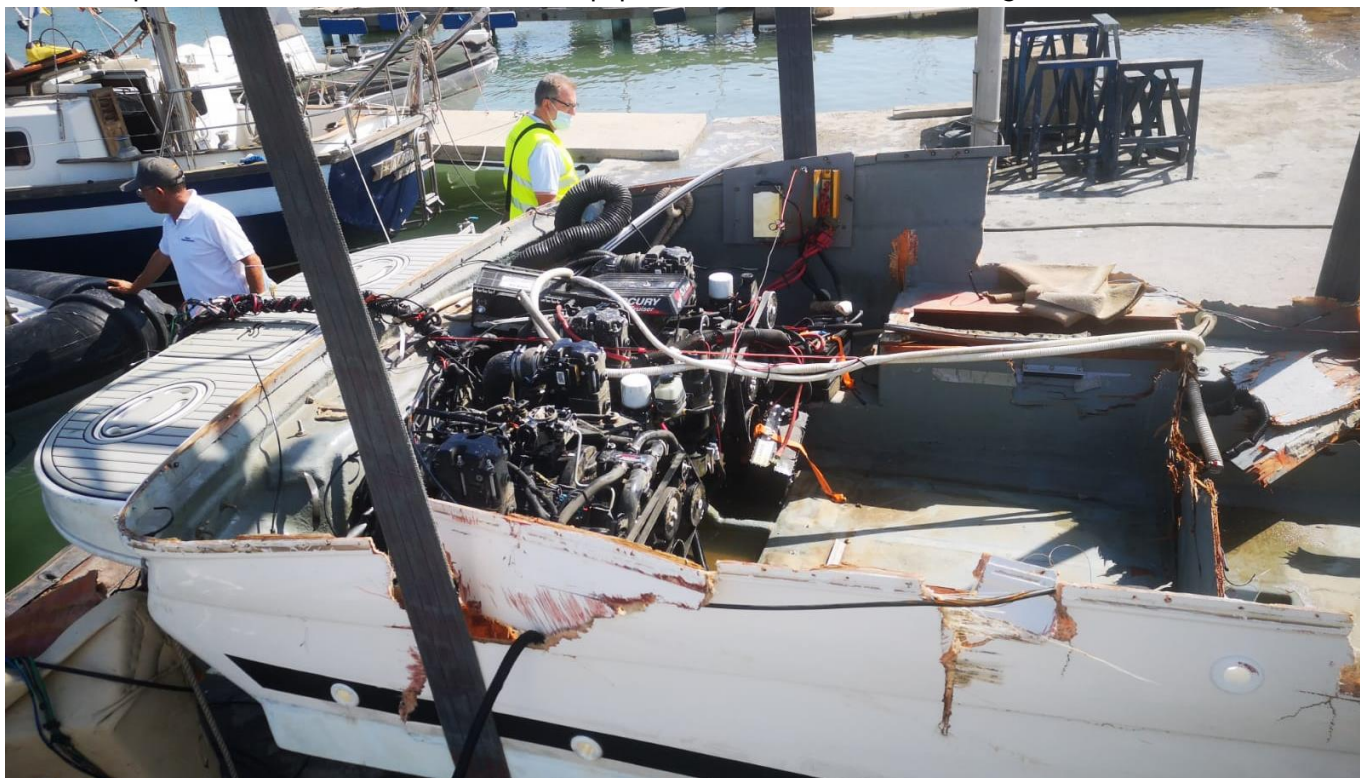
Figura 11. Zona de popa-estribor de la embarcación INDIA, puede apreciarse que la zona más a popa fue la menos afectada.
