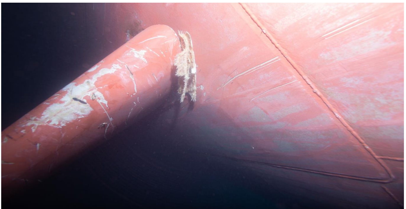
Figura 17. Estabilizador del patín de estribor. (Fuente: GEAS)
