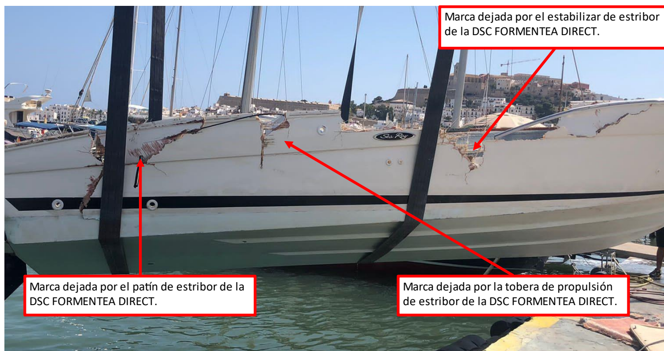
Figura 20. Costado de estribor de la embarcación INDIA
