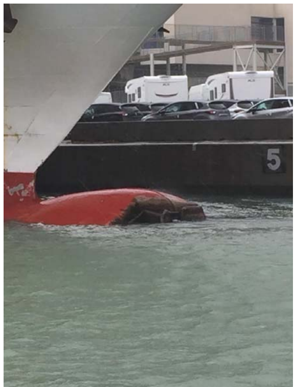
Figura 10. Daños en el bulbo
