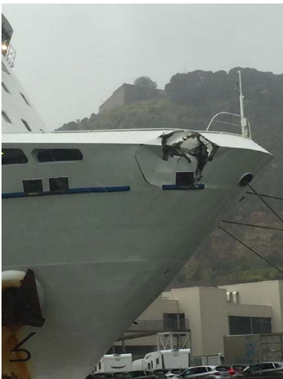
Figura 9. Daños en la amurada y cubierta de fondeo
