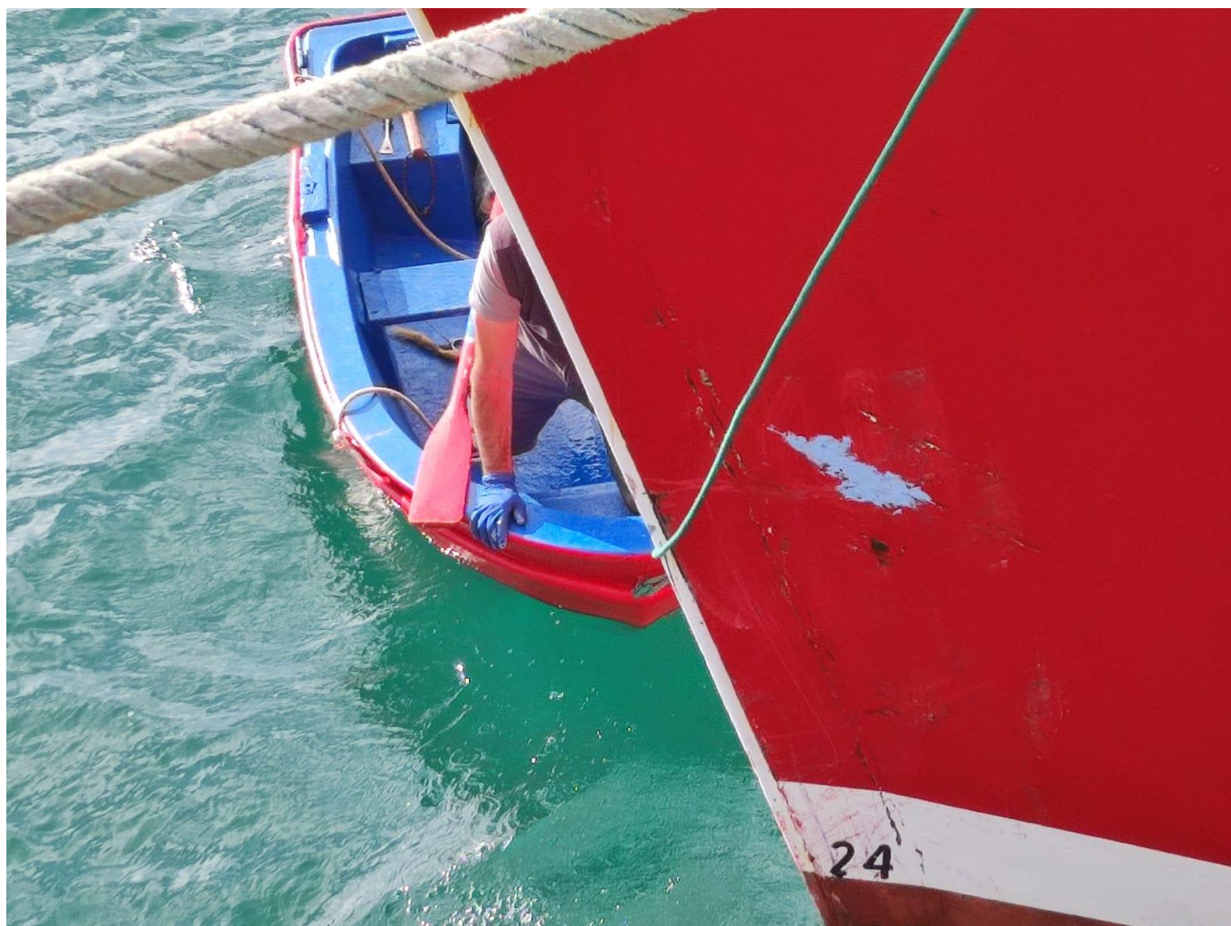
Figura 6. Detalle de los daños sufridos por el ZERUKO ERREGIÑA en el accidente
