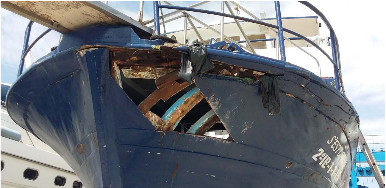
Figura 10. Rotura del casco en la amura de babor
