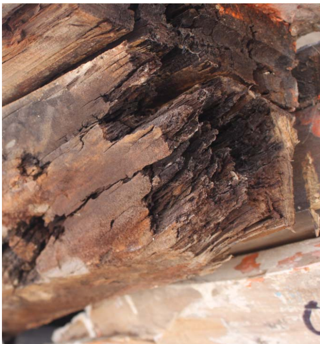
Figura 20. Estado de putrefacción de la madera de la embarcación S'ESTURION en la amura de babor
