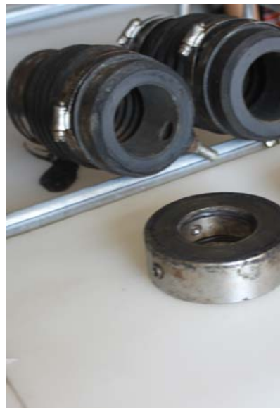
Figura 13. Cierre de la bocina desmontado
