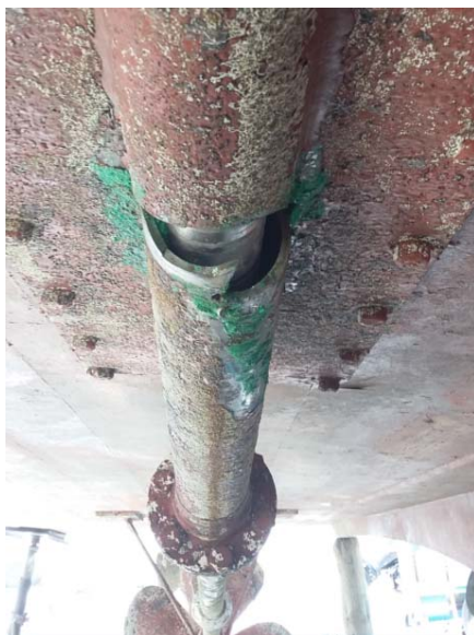
Figura 11. Rotura del tubo de la bocina de estribor
