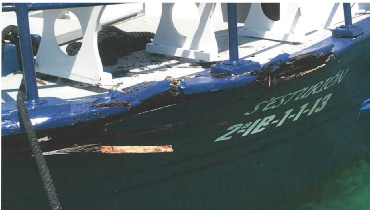
Figura 18. Daños en las obra muerta del casco producidos por el accidente del 19 de agosto de 2018
