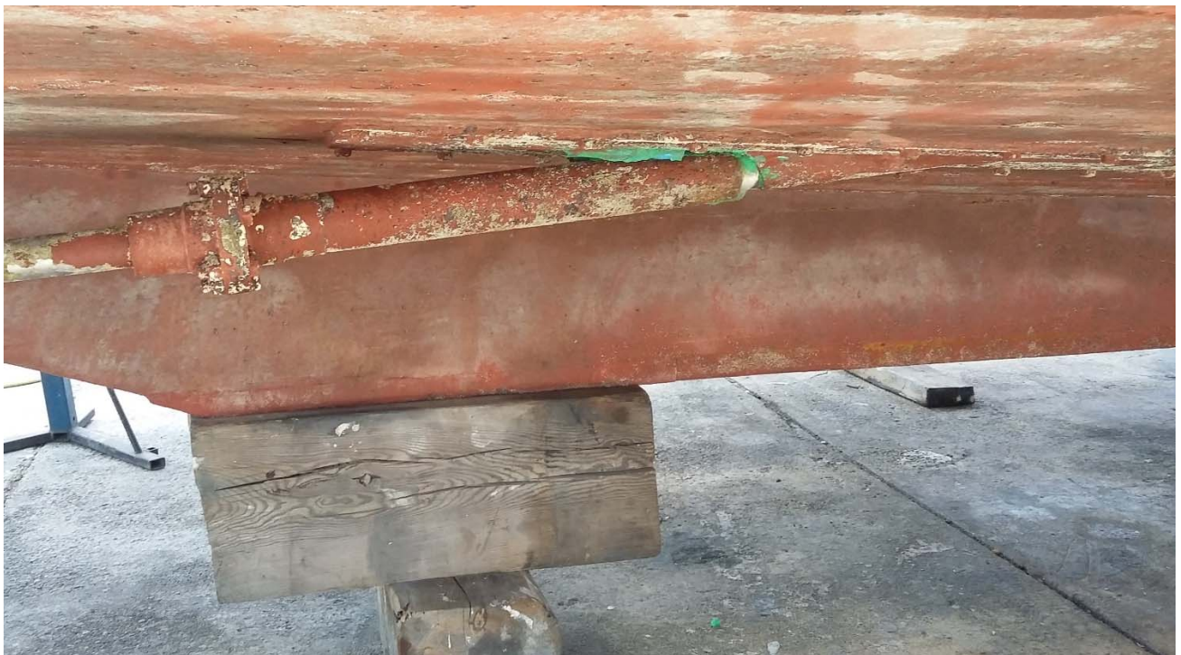
Figura 9. Daño en la línea de eje de estribor
