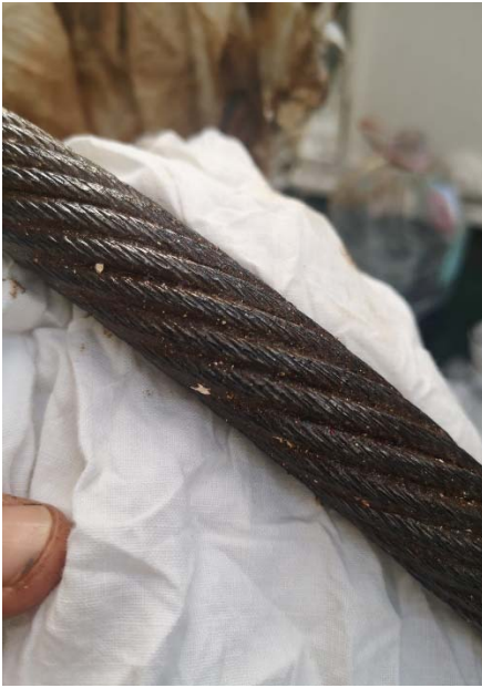
Figura 11. Superficie del cable en la mayoría de su extensión. Aparentemente en buen estado
