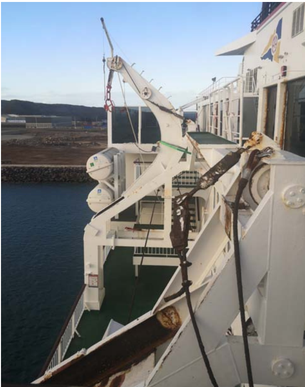
Figura 4. Brazo de popa del pescante del bote salvavidas nº3 después del accidente.
