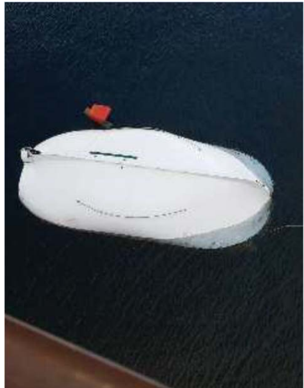
Figura 5. El bote salvavidas nº 3 del buque VOLCAN DEL TEIDE después de caer al agua.
