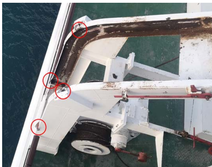
Figura 10. Localización de los puntos de deformación de las guías por los que salieron los cuatro rolines del brazo de proa
