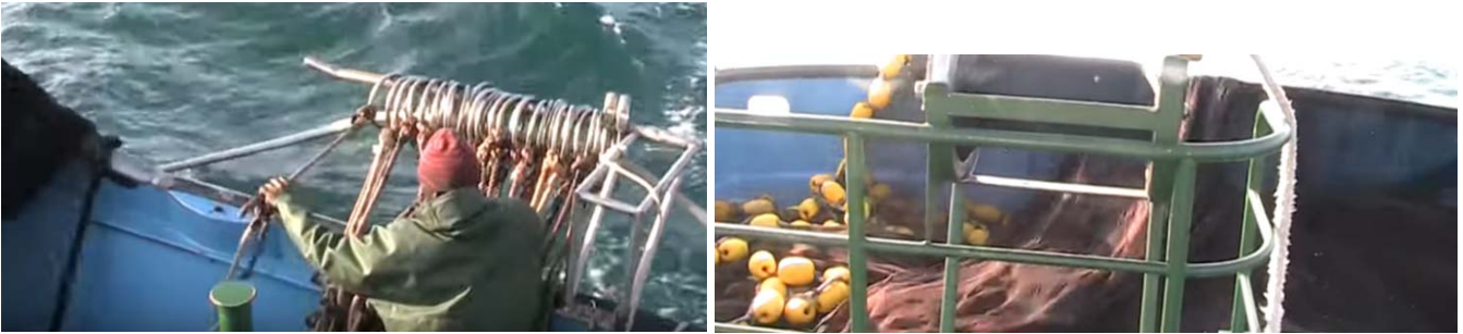
Figura 6. Detalles del arte. Anillas y cabos (izquierda), y relinga de corchos (derecha)
