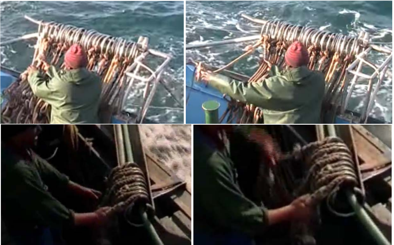
Figura 7. Posición del marinerero durante el lance y seguimiento manual de la salida de las anillas
