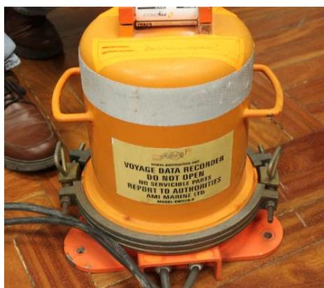
Figura 25. Componentes del RDT. Izquierda, unidad principal (el modelo no es exactamente el instalado a bordo). Derecha, cápsula blindada, recuperada del buque
