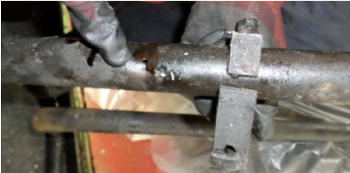
Figura 7. Detalle del poro y de la abrazadera de sujeción (Fuente: informe del armador)
