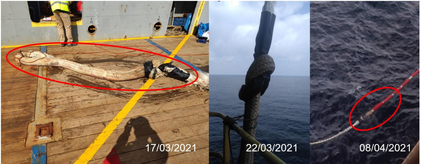
Figura 8. Vista de la zona de unión de los cabos principal y de sacrificio y de la presencia de los flotadores [Fuente: Capitanía Marítima de Bilbao, UOPJ de Vizcaya y ENAGÁS TRANSPORTE]
