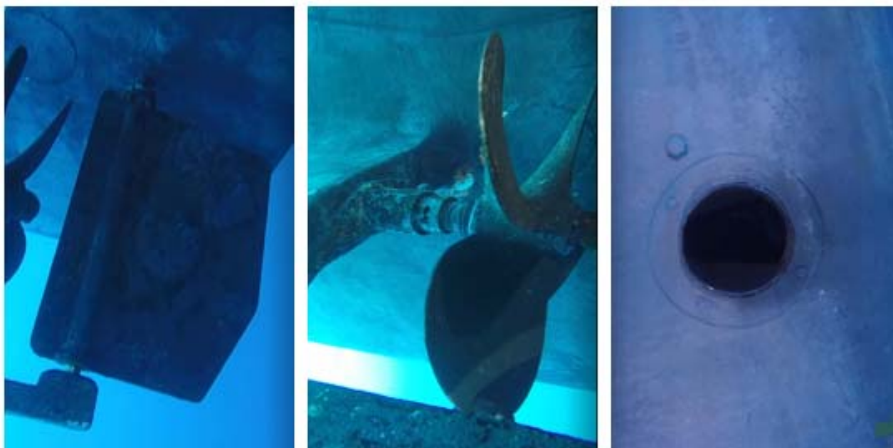
Figura 7. Timón, hélice y escape húmedo de la embarcación LA FLECHERA
