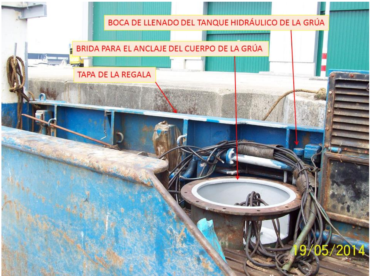
Figura 4. Zona donde se halla la grúa y la boca de llenado de su tanque hidráulico
