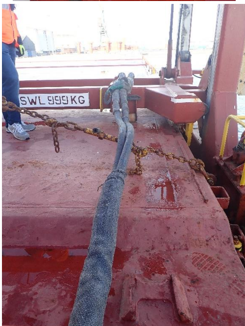
Figura 6. Visión del tramo de 20 m de línea de remolque correspondiente a la puntera (cabo "azul"), que se encontraba íntegra, desplegada a bordo del ANNE, secuencia de arriba abajo y de izquierda a derecha (fotos de la CIAIM)
