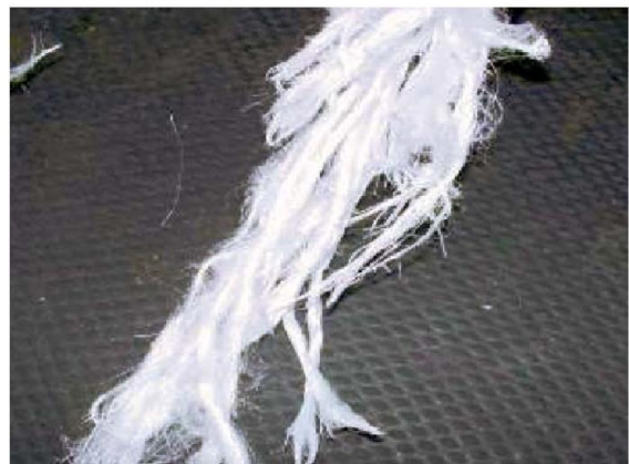
Roto debido a sobrecarga.
