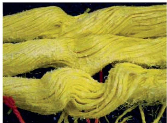
Enredos de un cabo como resultado de una suelta repentina.
