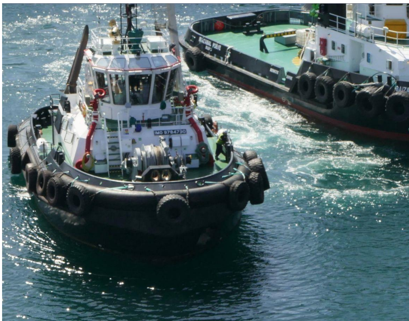
Figura 4. El remolcador IBAIZABAL DOCE, visto por la proa. Adviértanse la maquinilla y las gateras pasacabos y su posición relativa respecto del Puente de gobierno.
