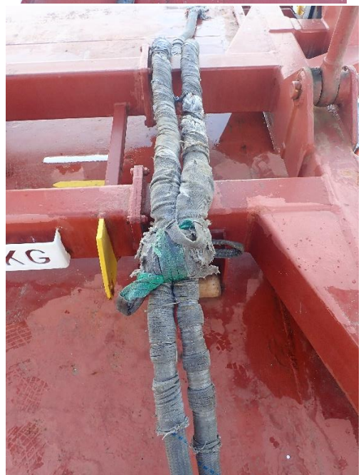
Figura 6. Visión del tramo de 20 m de línea de remolque correspondiente a la puntera (cabo "azul"), que se encontraba íntegra, desplegada a bordo del ANNE, secuencia de arriba abajo y de izquierda a derecha (fotos de la CIAIM)
