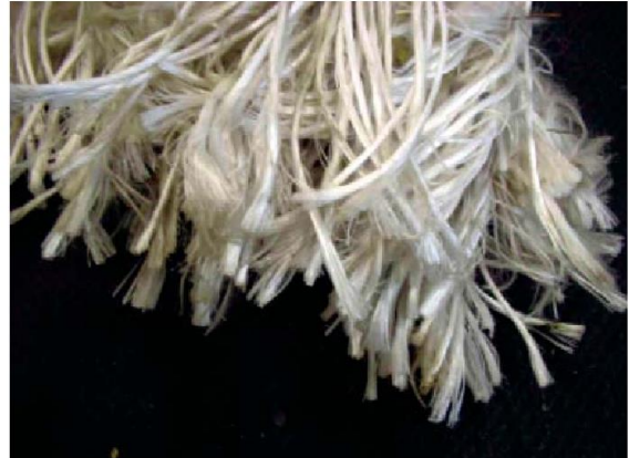
"Corte limpio", roto en borde afilado.
