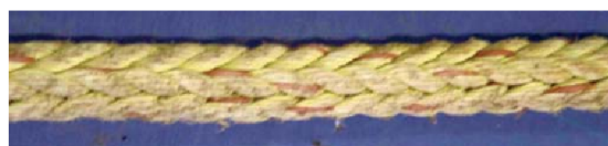
CABO USADO, PERO AÚN UTILIZABLE
