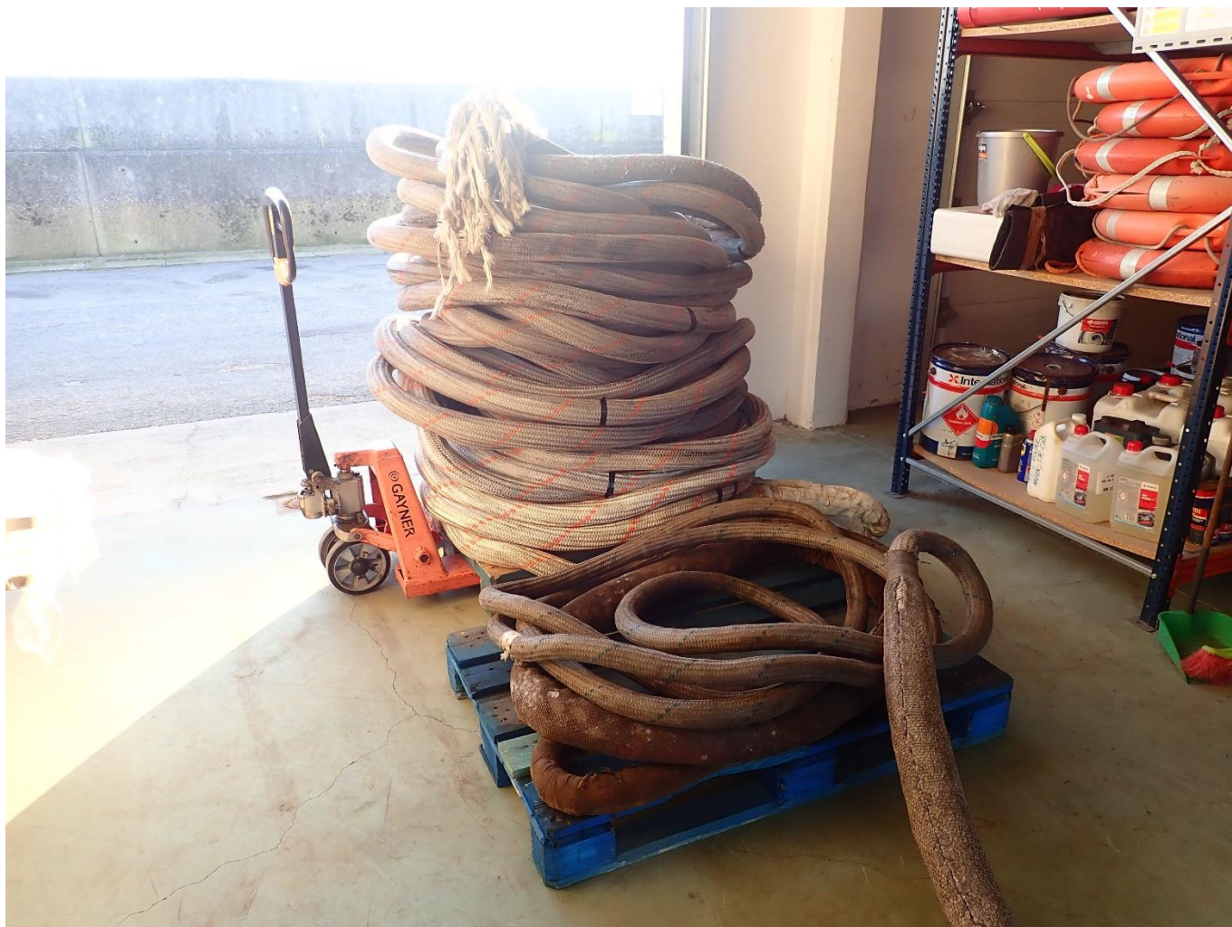
Figura 8. Cabos “azul” y “naranja” recogidos sobre pallets. Véase la rotura de la “parte del remolcador”
