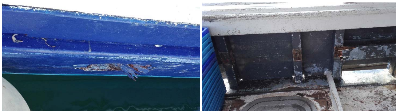
Figura 7. Daños en el costado del JUAN Y ANGELA producidos por el abordaje
