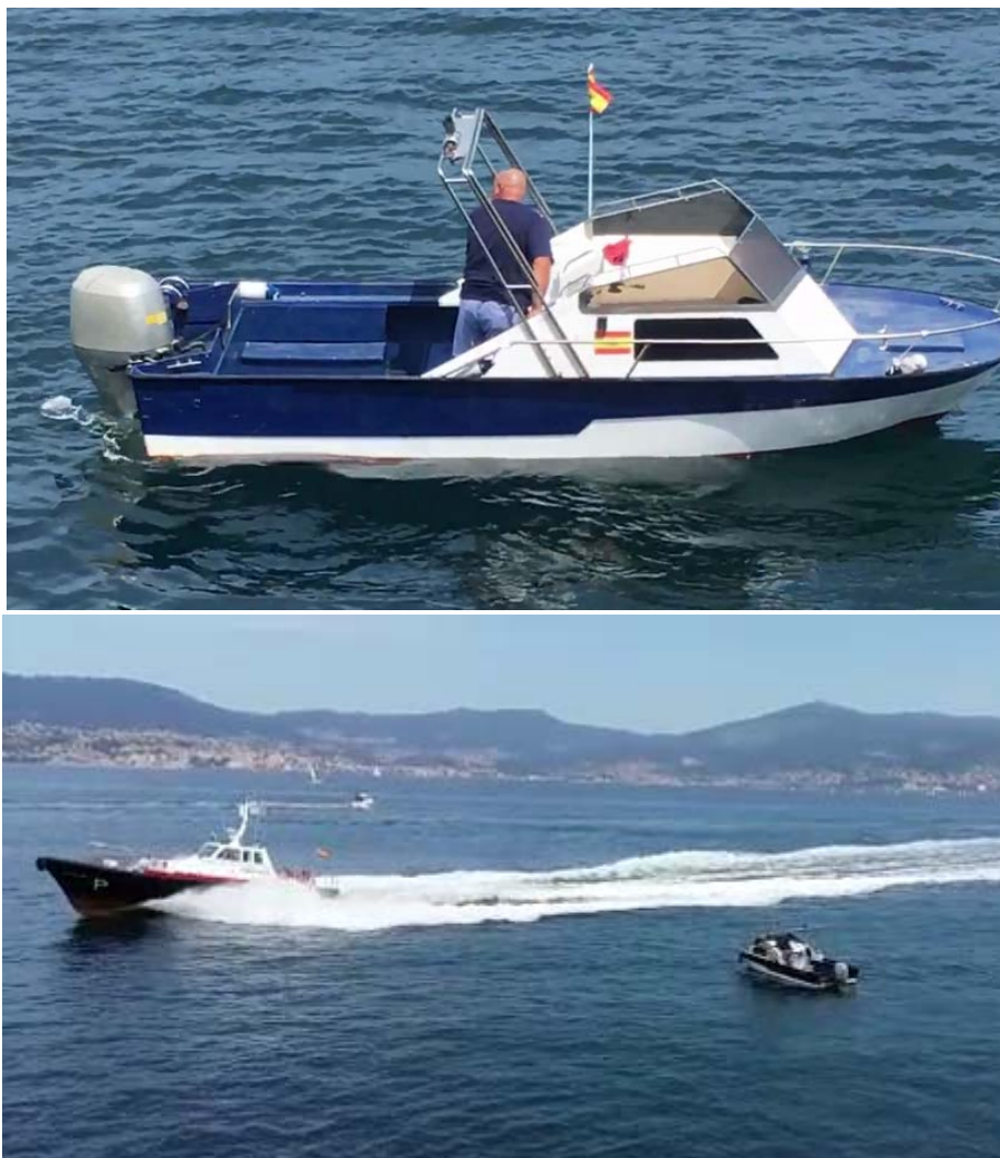
Figura 12. Pruebas realizadas tras el accidente para estudiar la influencia de la estela (1)
