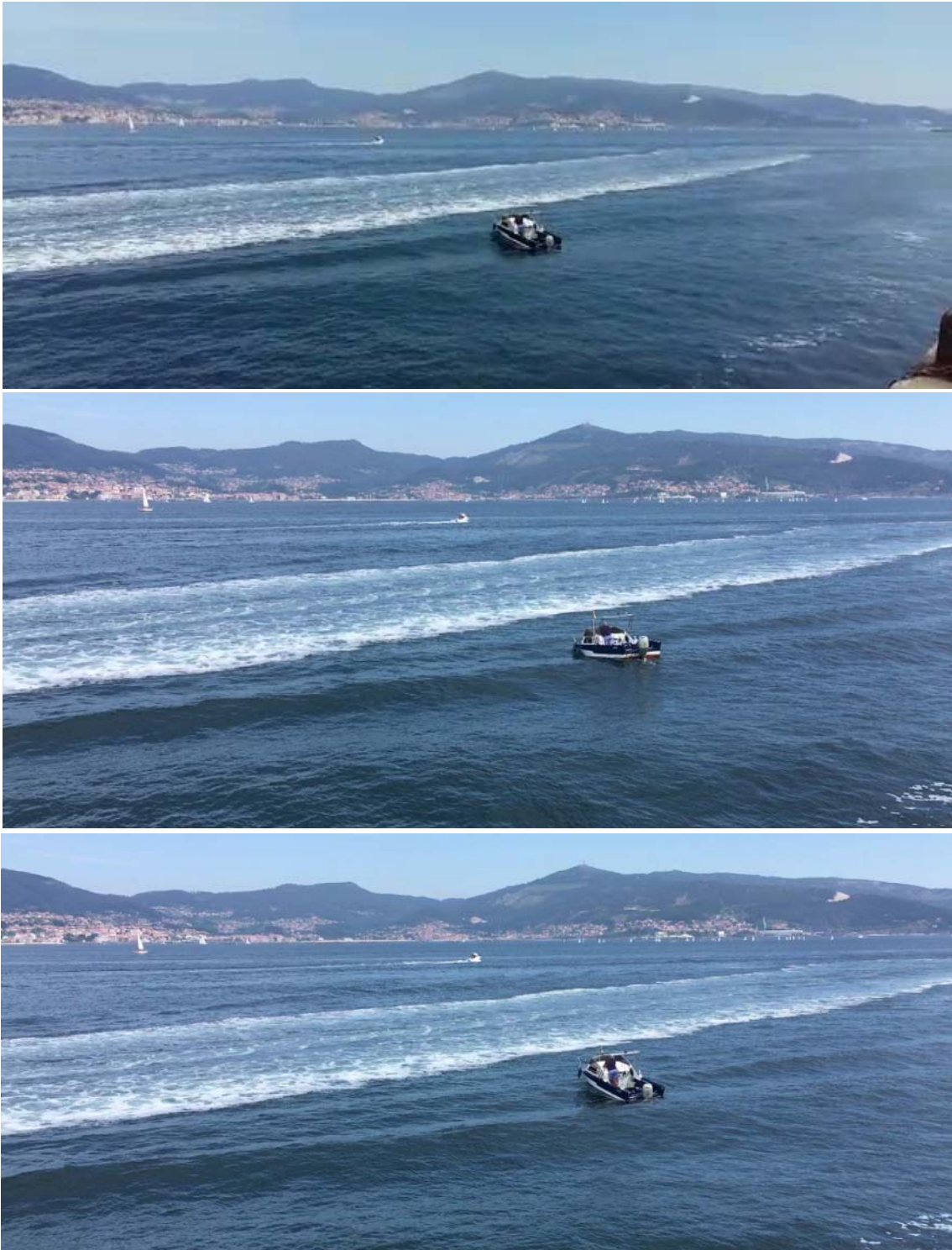
Figura 13. Pruebas realizadas tras el accidente para estudiar la influencia de la estela (2)
