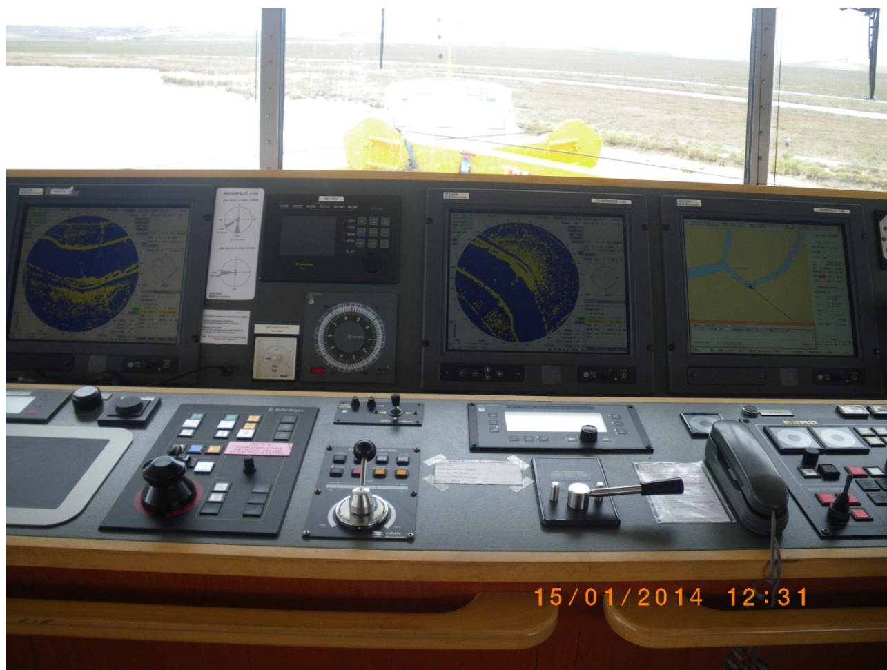
Figura 5. Detalle del puesto de control del buque, en la medianía del puente, con ambos radares, repetidor de giroscópica y el ECDIS a la vista.
