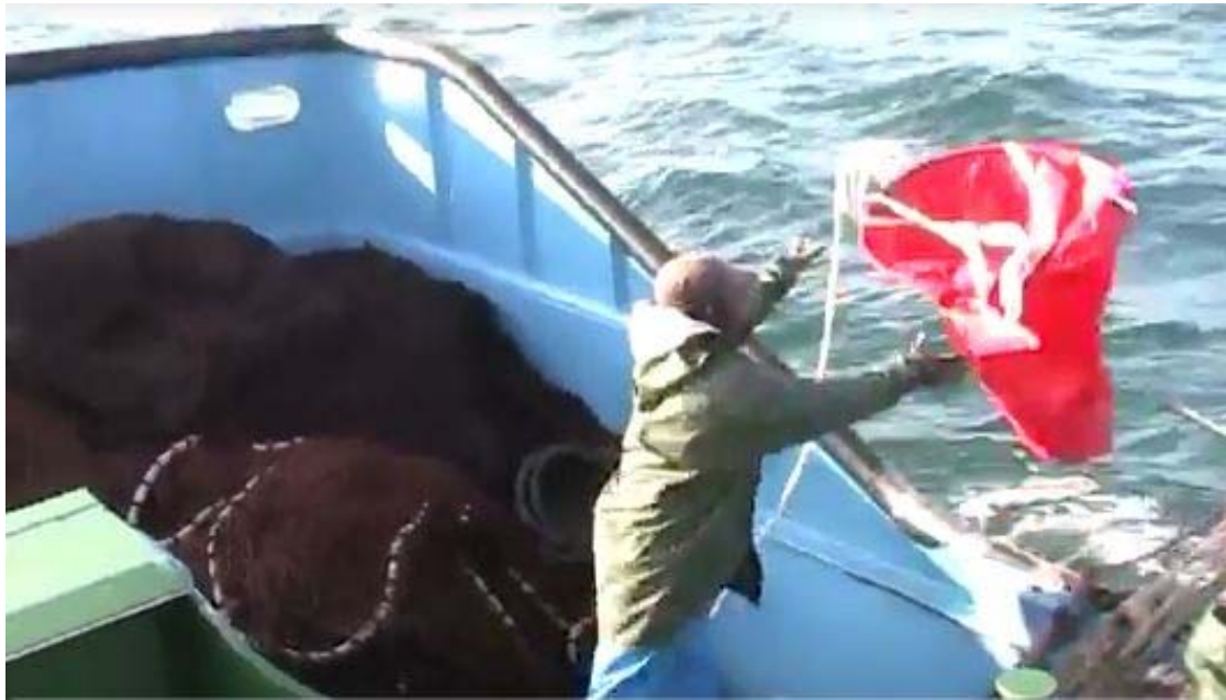
Figura 5. Largado del ancla flotante. La foto corresponde a un barco similar al B/P ALMIRANTE BERRIA
