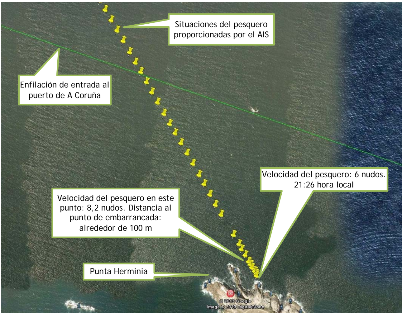
Figura 5. Representación de los datos aportados por el sistema AIS
