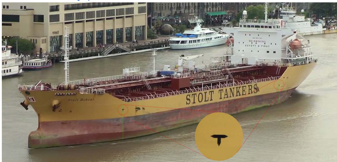
Figura 9. Puntos de empuje de remolcadores.
