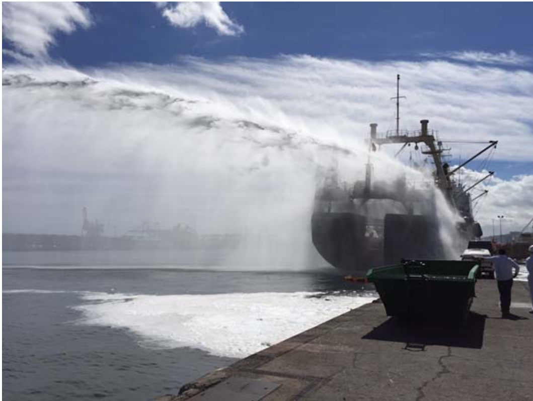
Figura 15. Labores de enfriamiento del casco desde el mar
