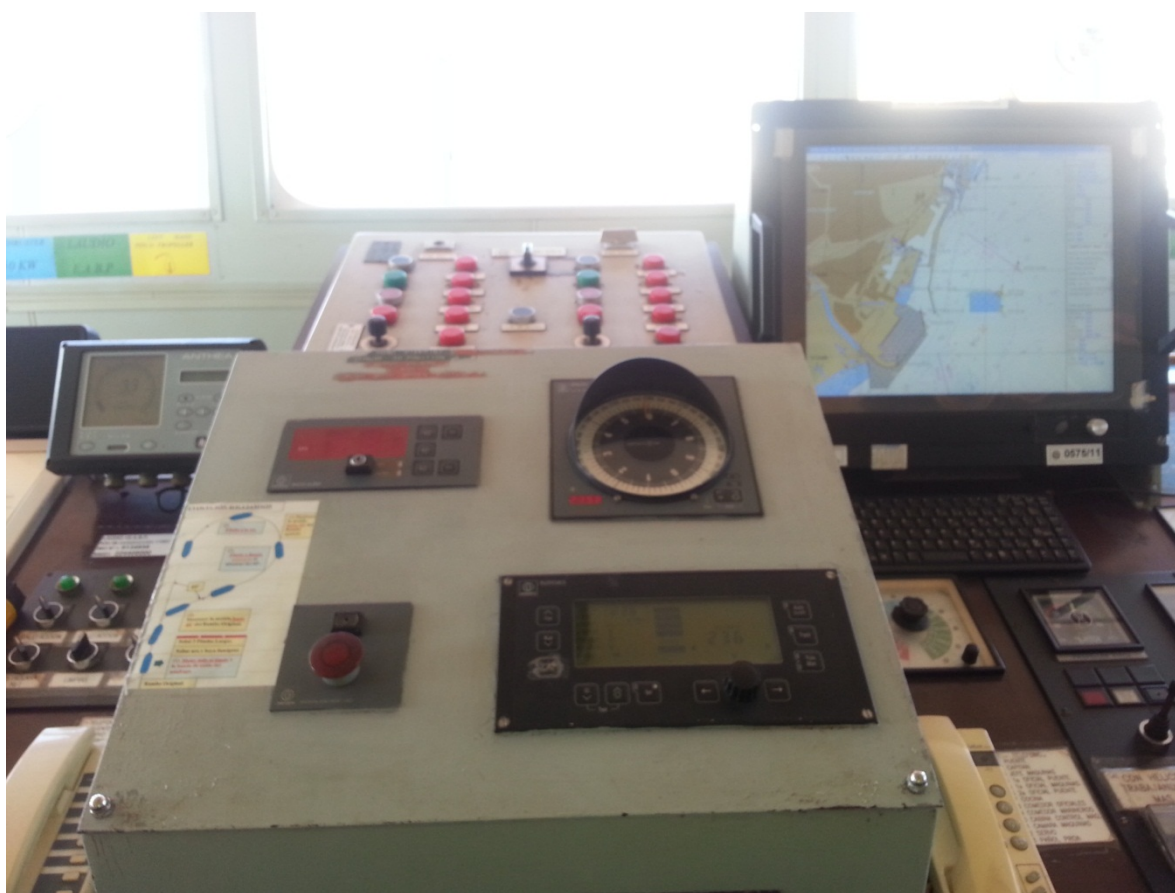
Figura 10. Consola de gobierno, con el SIVCE al lado y las ventanas al fondo de la imagen
