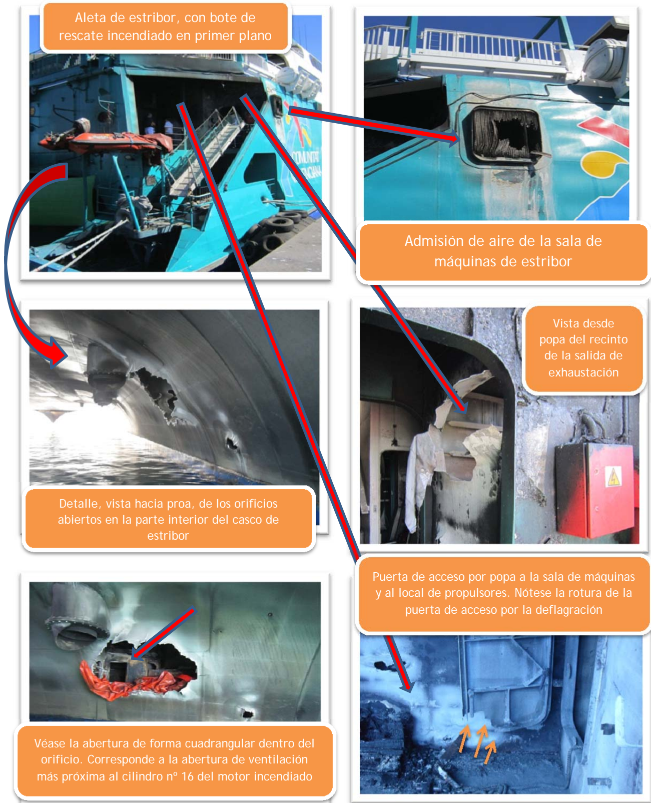
Figura 3. Vistas de algunos de los daños visibles desde el exterior sufridos por el JAUME I.
