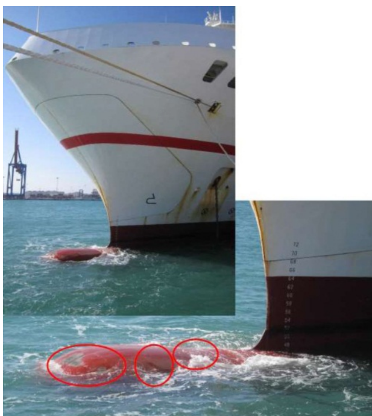
Figura 3. Daños visibles en bulbo
