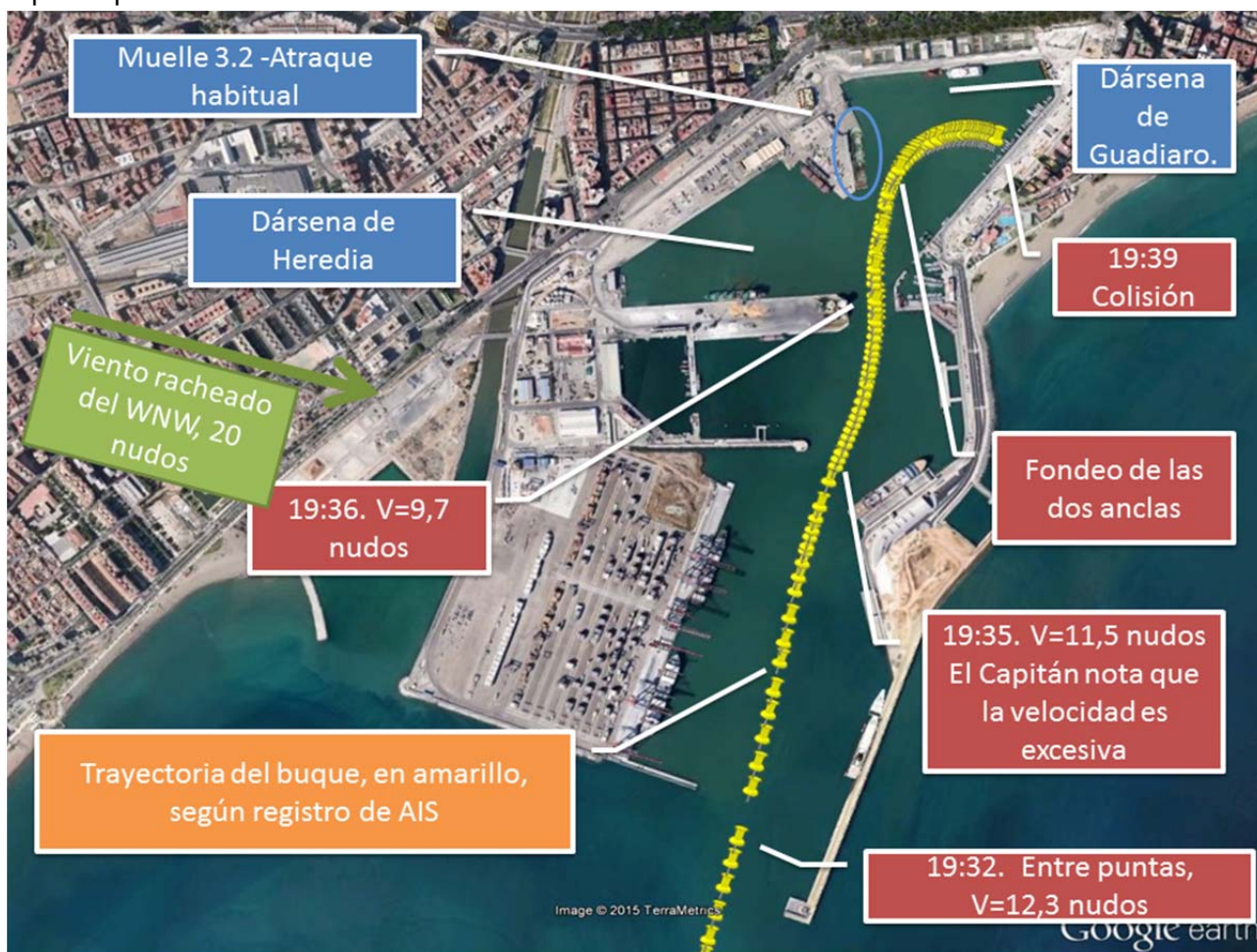
Figura 6. Registro de AIS de la aproximación del buque al puerto hasta la colisión
