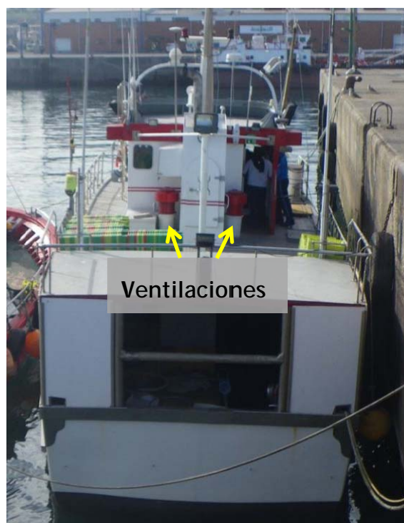
Figura 10. Ventilaciones de la cámara de máquinas
