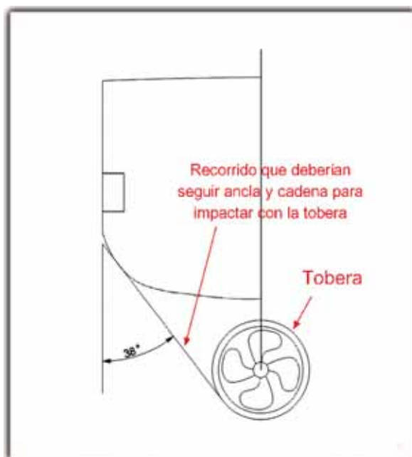
Figura 13. Croquis que muestra el ángulo de impacto sobre la tobera de la hélice
