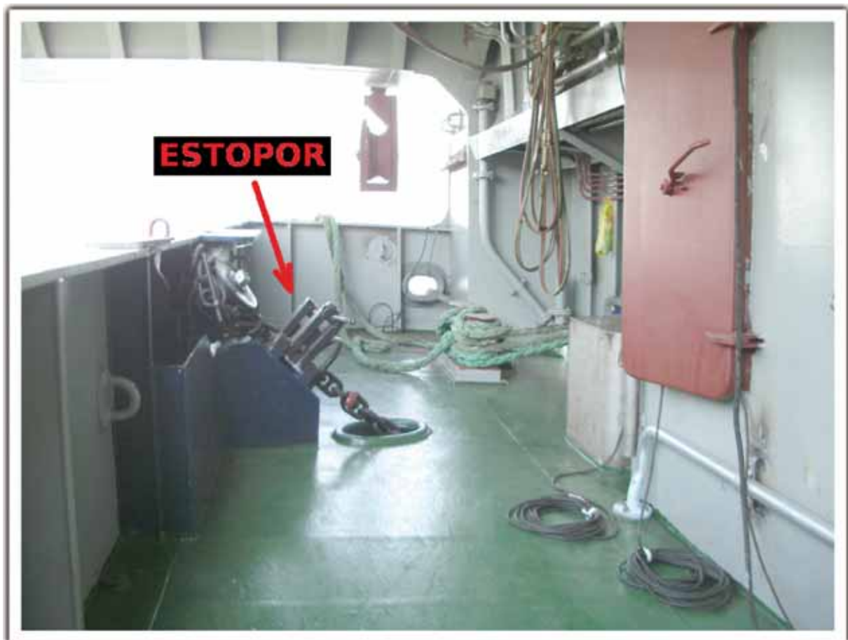
Figura 4. Vista del estopor de la cadena del ancla de babor
