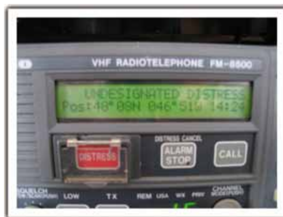
Figura 5. Posición y hora del accidente, recuperadas del dispositivo de LSD del B/P RIO ORXAS
