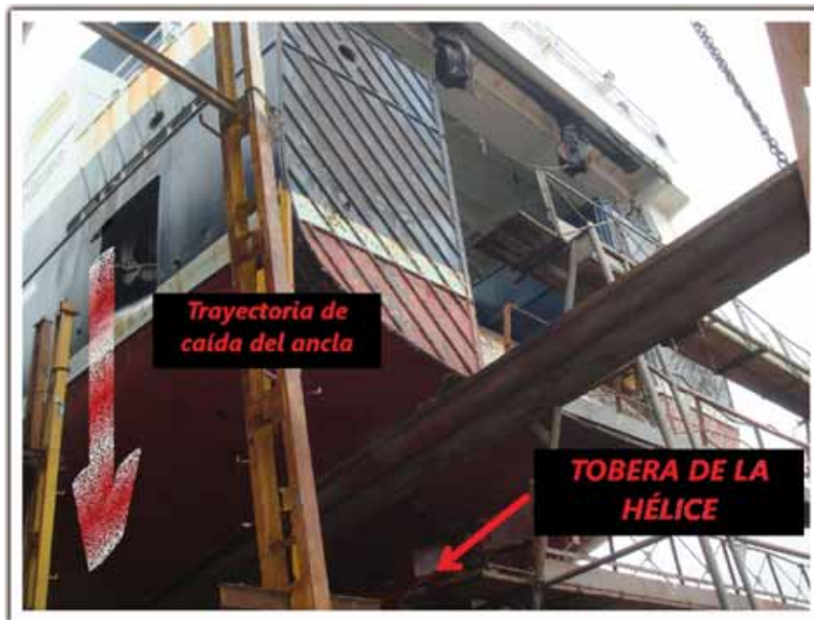
Figura 12. Vista de la parte posterior del buque en varadero, donde se aprecia la trayectoria de caída del ancla de babor respecto de la posición de la tobera de la hélice
