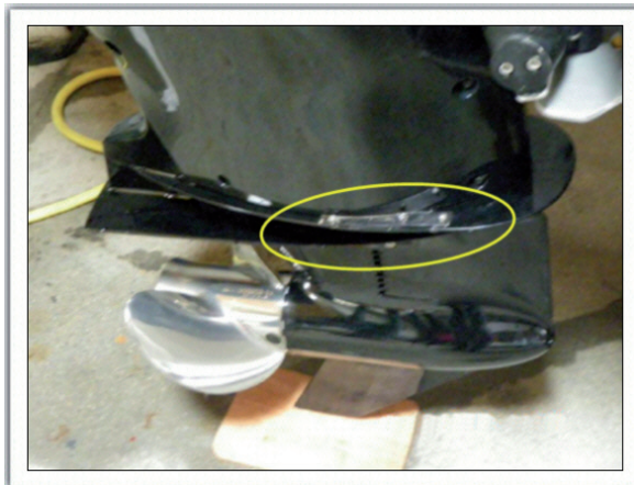
Figura 20. Daños en el motor de la embarcación MAR DE AGUIÑO
