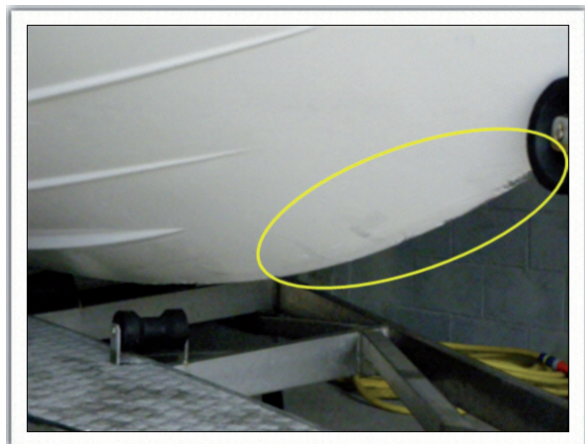
Figura 17. Daños en la roda de la embarcación MAR DE AGUIÑO
