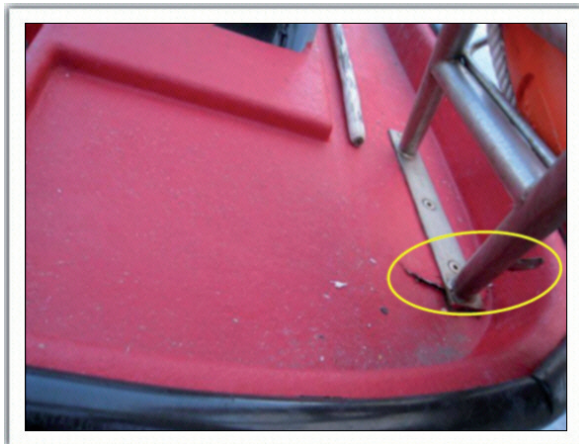
Figura 15. Daños en la cubierta de la embarcación VAI BEN, en la popa en estribor
