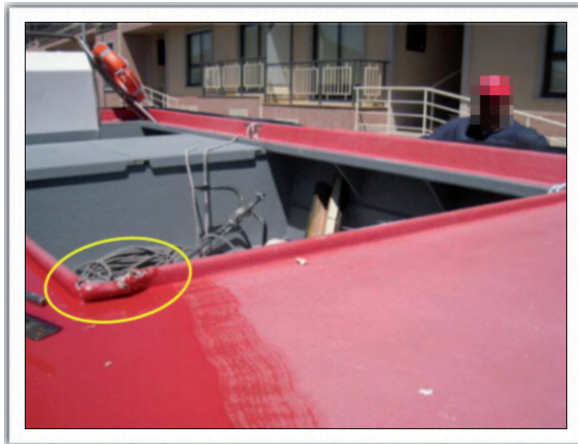
Figura 9. Daños en la cubierta de la embarcación CIMA, en la proa en estribor. Fotografía sacada desde la proa en estribor
