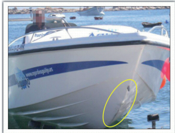
Figura 16. Daños en la roda de la embarcación MAR DE AGUIÑO
