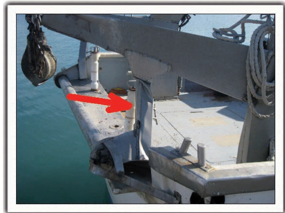
Figura 13. Daños en el soporte del pescante
