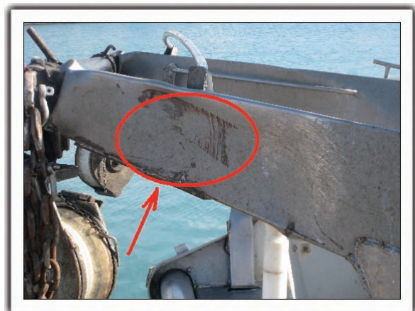
Figura 14. Detalle del impacto en el pescante a estribor
