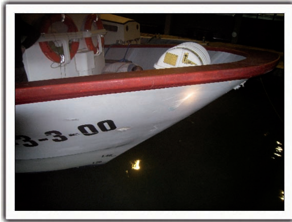
Figura 2. Zona de proa del B/P PRINÇES en donde se produjeron los daños
