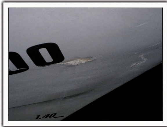
Figura 11. Hendidura secundaria en la amura de estribor del B/P PRINÇES
