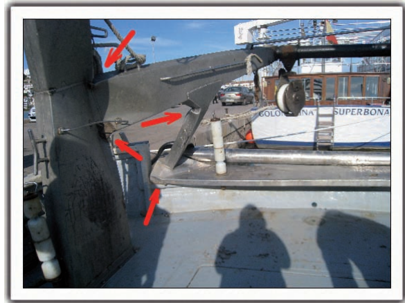
Figura 15. Vista de los daños de pescante y barra de pastecas desde el interior del barco
