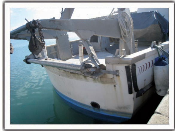
Figura 3. Daños a la estructura del pescante y pórtico del B/P LLUNA
