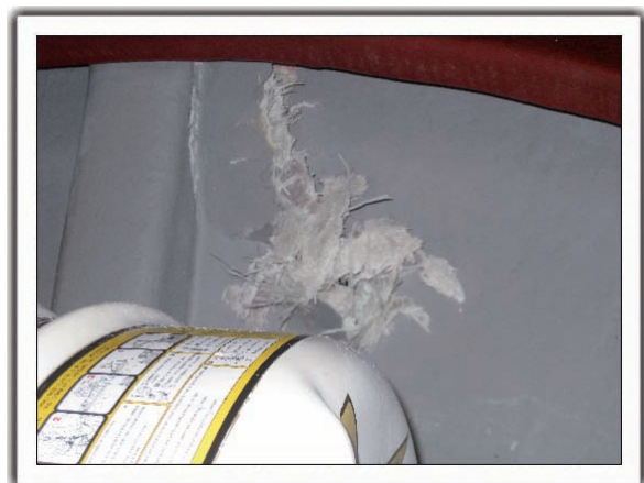
Figura 10. Deslaminación producida en la regala, por la hendidura principal
