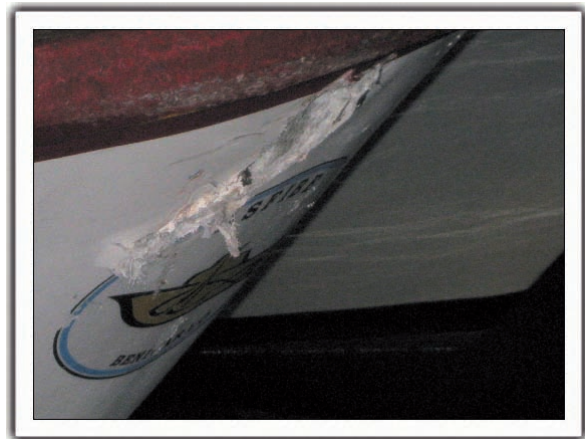
Figura 9. Detalle de la hendidura principal en la proa del B/P PRINÇES
