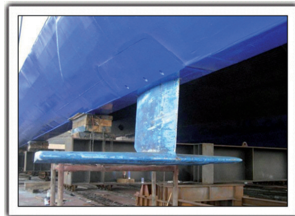
Figura 4. Aleta sustentadora en T ( T-foil ) en la proa del buque BONANZA EXPRESS
