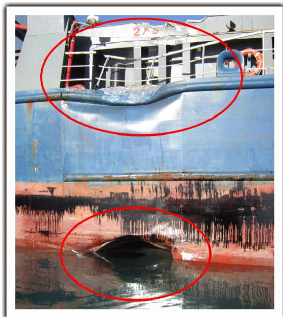
Figura 5. Daños en el casco del buque EMS
