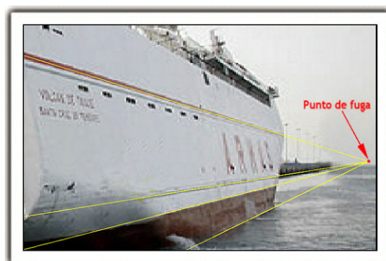
Figura 6. Comprobación del asiento del buque tras el incidente.
