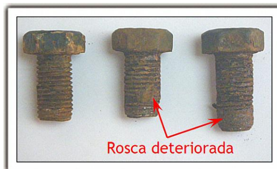
Figura 10. Estado de los tornillos rotos
