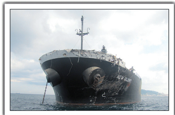
Figura 7. Daños en el buque NEW GLORY
