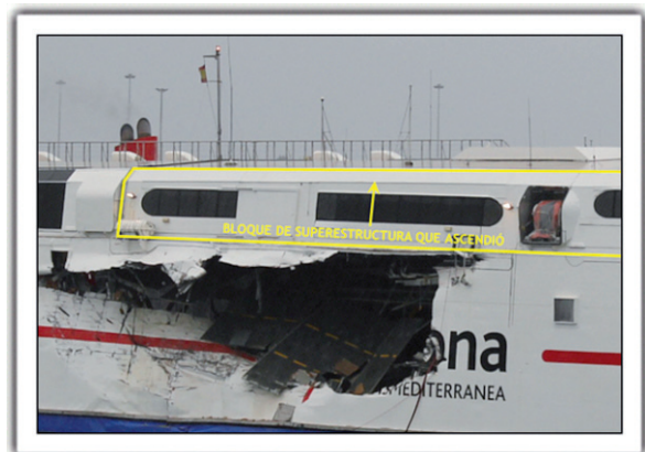
Figura 17. Bloque de la superestructura del buque MILENIUM DOS que quedó levantado
