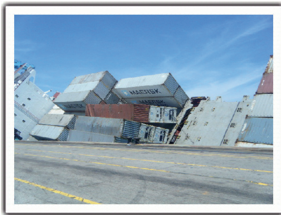
Figura 7. Contenedores sobre bodega 2 cuyos anclajes no soportaron la escora
