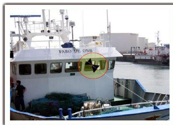
Figura 8. Marca de pesca al arrastre según la regla 26 del RIPA, mostrada por el B/P FARO DE ONS atracado en puerto
