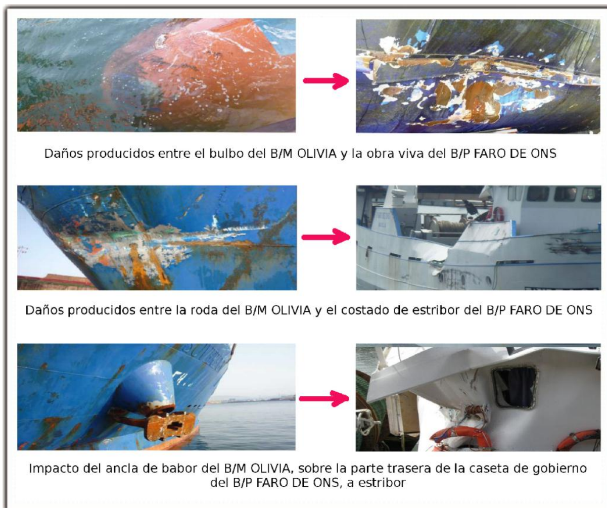
Figura 4. Daños sufridos por ambos buques
