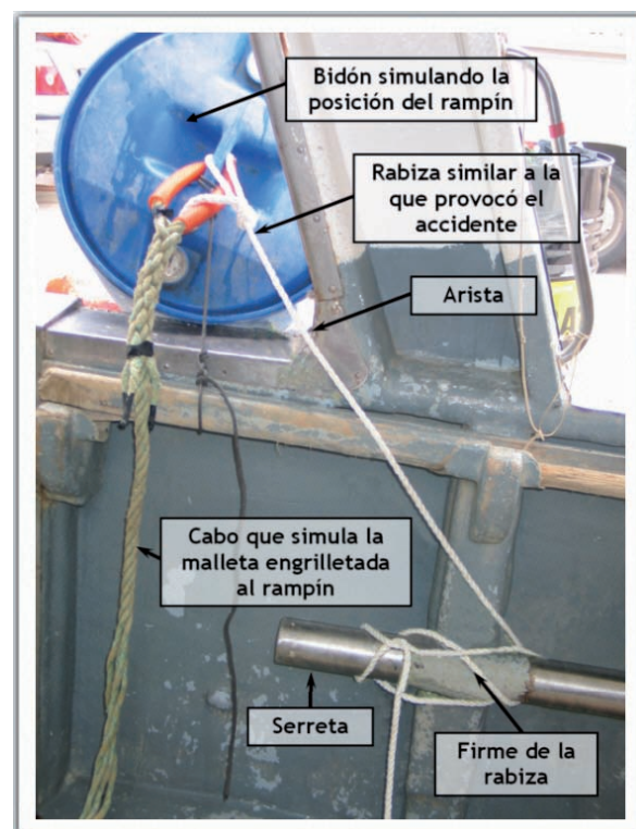
Figura 12. Simulación del utillaje para el lanzamiento del rampín, en el momento del accidente
