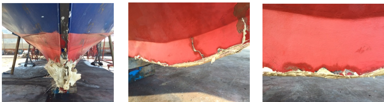
Figura 4. Daños del B/P HERMANOS CERVILLA, en el exterior
