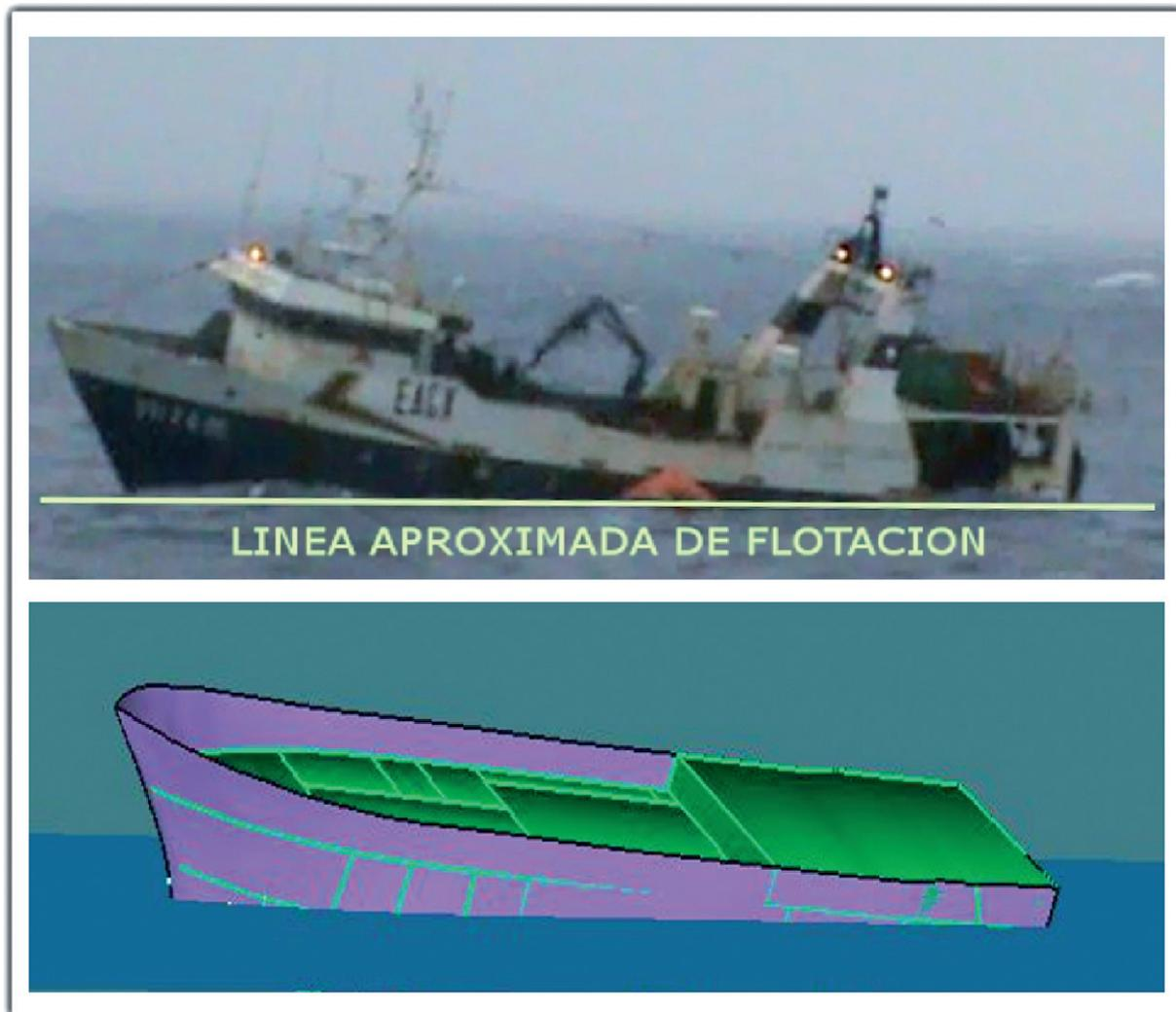
Figura 18. Comparación de las flotaciones de la fotografía y el modelo
