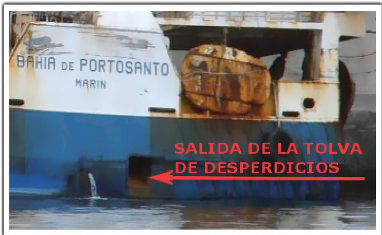
**Figura 5.** Descarga de la tolva de desperdicios del B/P BAHÍA DE PORTOSANTO en 2008
