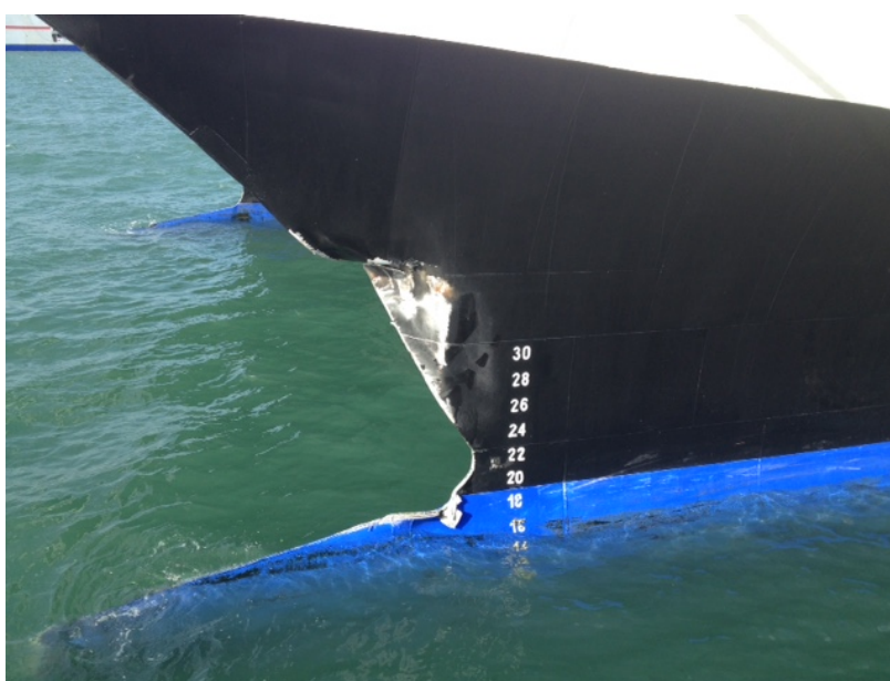
Figura 8. Daños en el casco de babor
