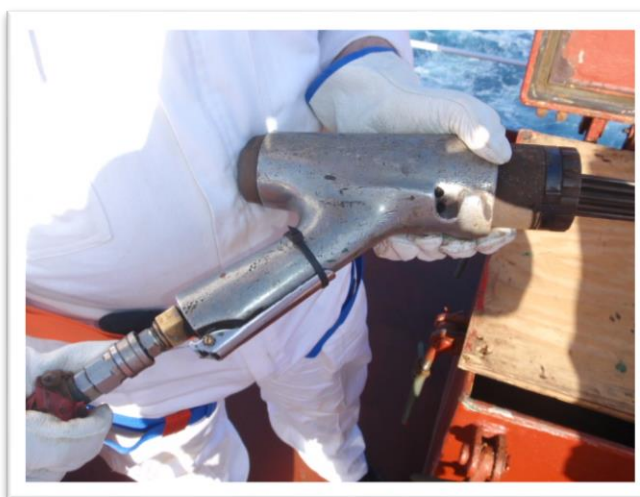
Figura 5. Piqueta utilizada para el trabajo. Nótese la brida aprisionando el gatillo.
