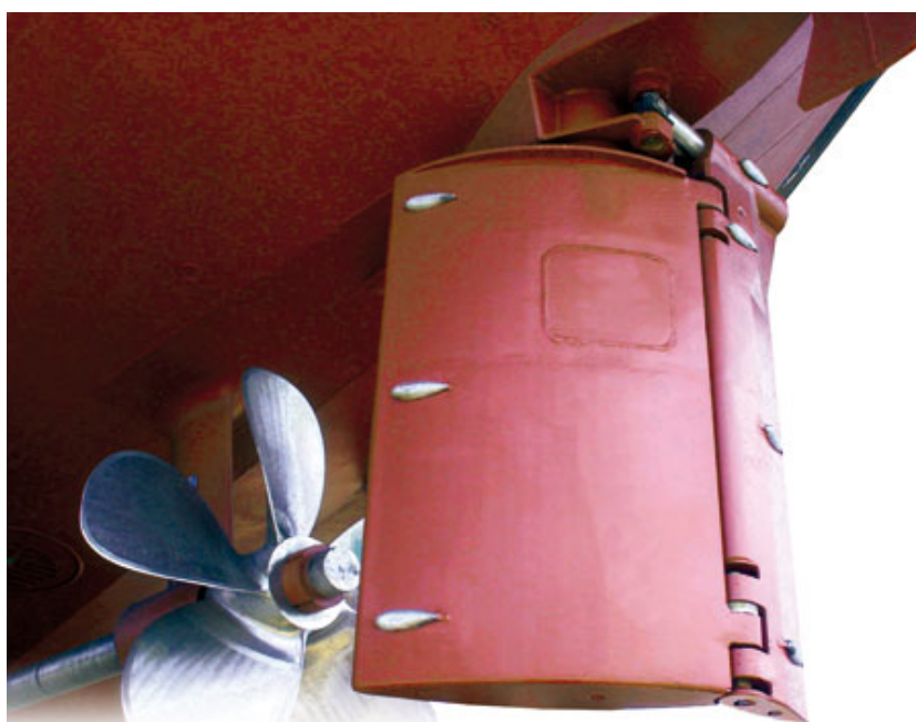
Figura 3. Timón Becker (imagen obtenida de la web del fabricante)
