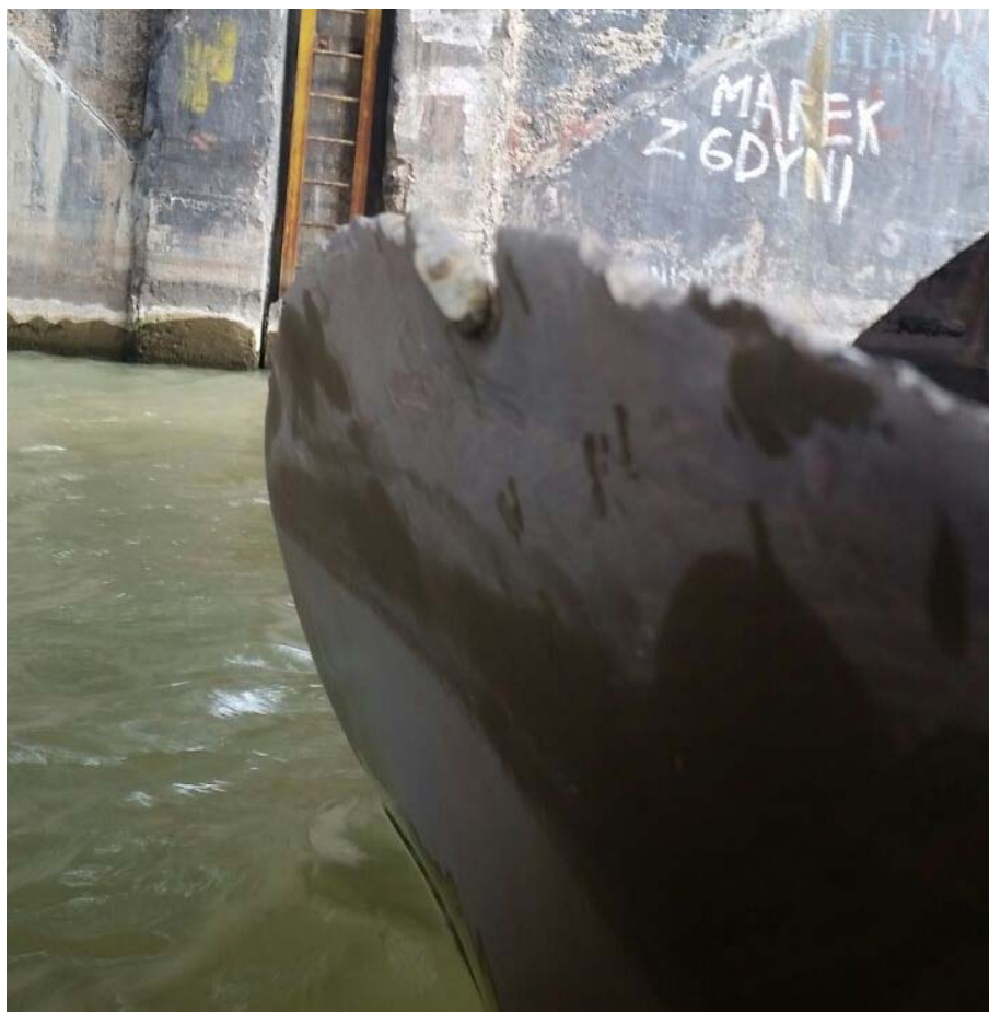
Figura 6. Daños en una pala de la hélice
