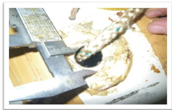
Figura 16. Arriba, conjunto de boza, rabiza y nudo doble en esta última. Abajo, detalle del orificio de salida de la boza
