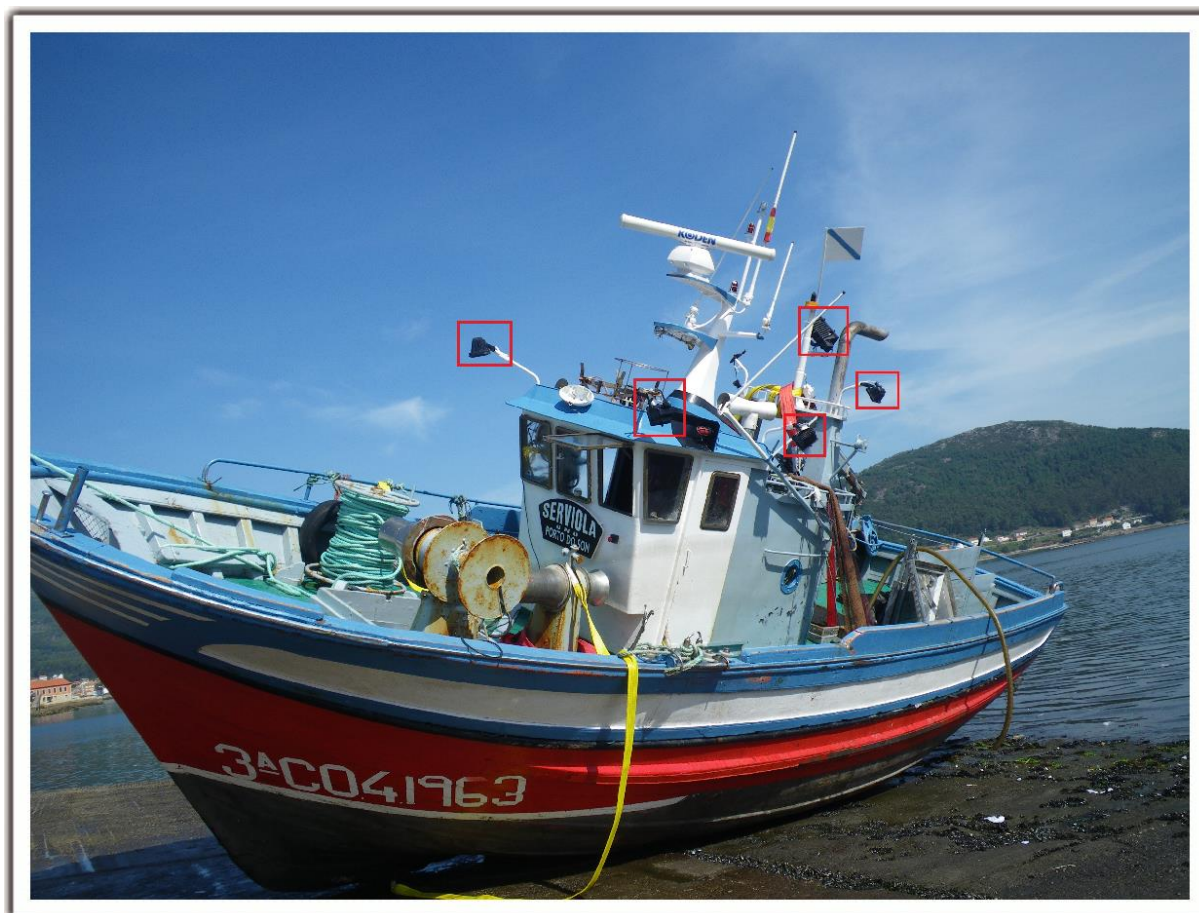
Figura 5. Focos para iluminar la cubierta.
