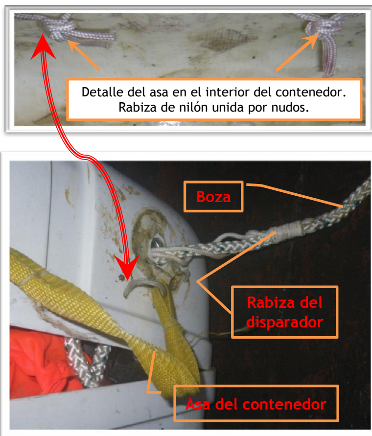
Figura 14. La boza de la balsa, junto con la rabiza que acciona el disparo de la botella, a punto de salir completamente. Nótese el detalle del asa visto desde el interior del contenedor y que se marca por la flecha de color rojo.
