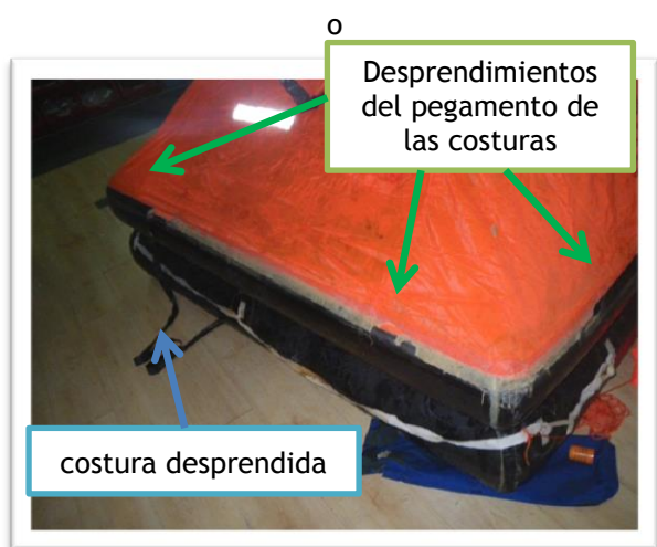
Figura 19. Detalle de las costuras de la balsa
