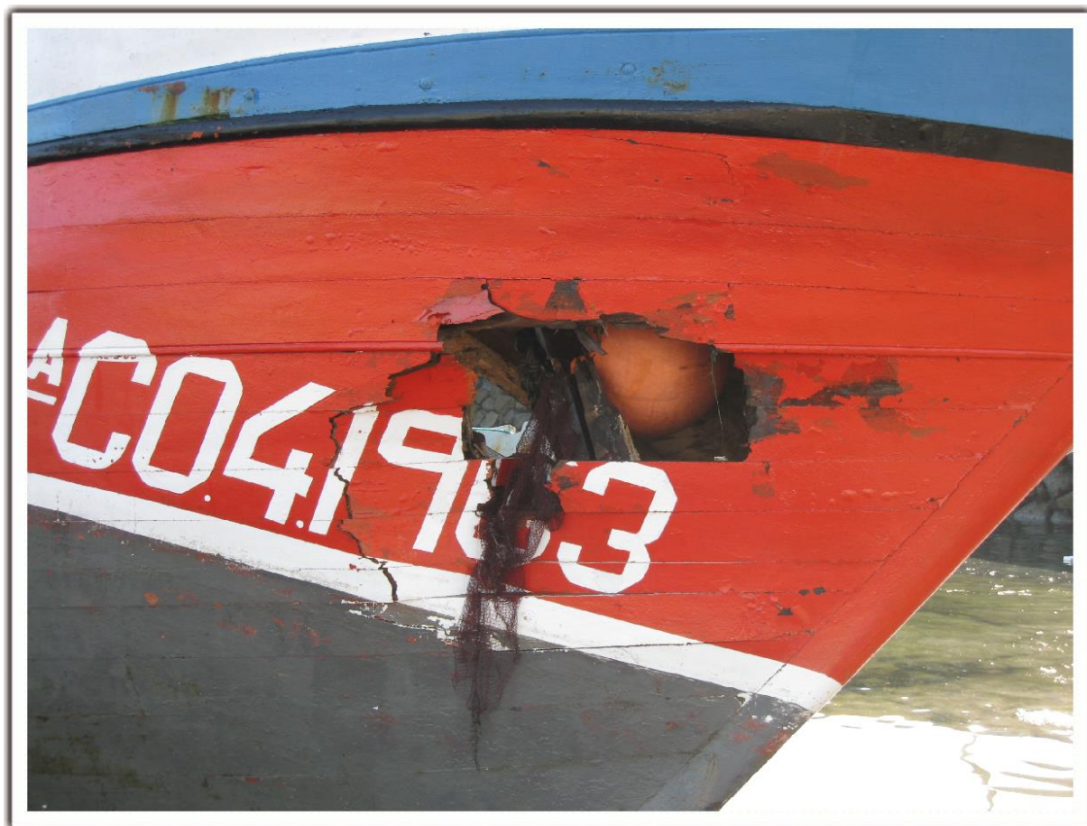
Figura 7. Daños en la E/P SERVIOLA UNO.
