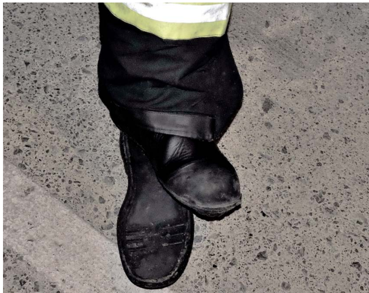
Figura 30. Bota de un bombero con la suela despegada por el calor
