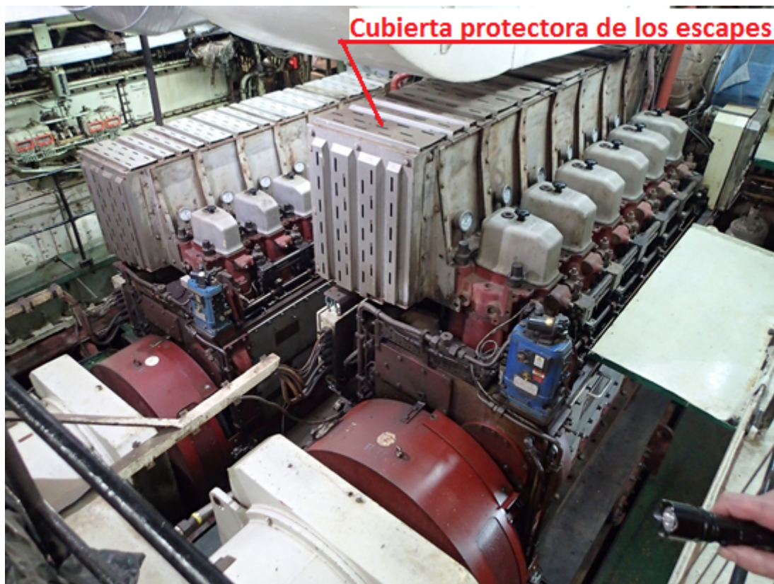
Figura 21. Disposición de auxiliares MAK 6M20C en un buque gemelo
