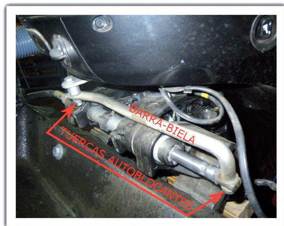
Figura 7. Detalle de la sujeción de la barra-biela de dirección
