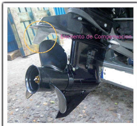
Figura 8. Elemento para la compensación de la tendencia de caída del motor
