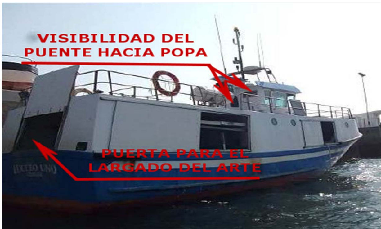
Figura 7. Vista de la embarcación donde se observa la ubicación de las ventanas del puente
