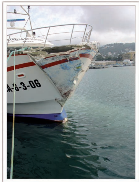
Figura 10. Daños en la amura de estribor del pesquero
