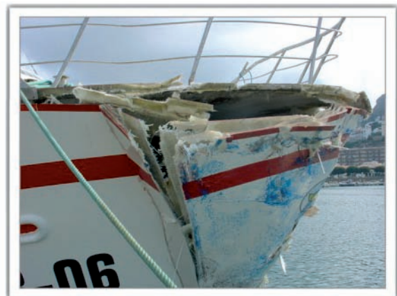
Figura 3. Consecuencias del impacto sobre la proa del pesquero
