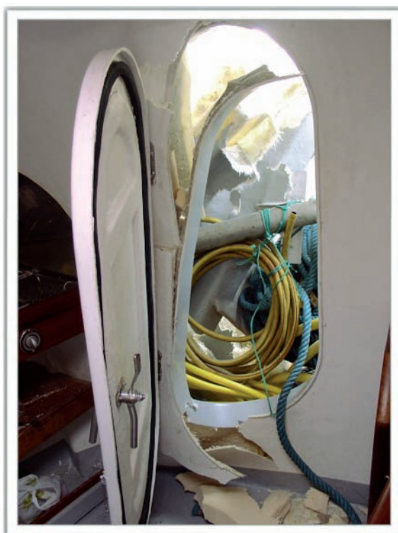
Figura 11. Obstrucción de la entrada al pañol de proa
