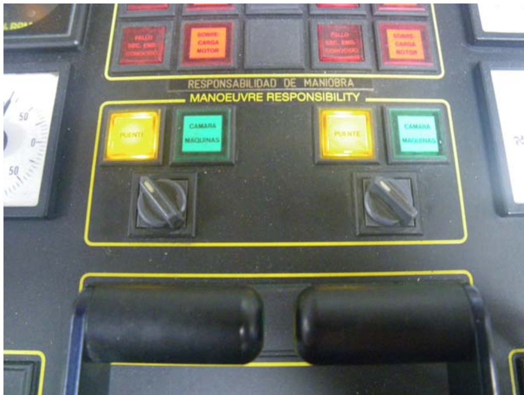
Figura 10. Detalle en la máquina de cambio de responsabilidad puente-máquina con selector giratorio
