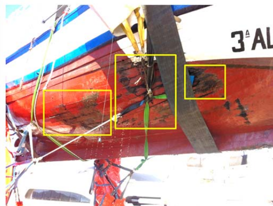
Daños en la tablazón de estribor
