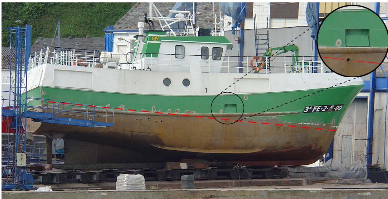
Figura 7. Abertura sin cierre en la embarcación SAFRÁN. Se ha indicado con una línea roja de trazos la flotación a la salida de puerto.
