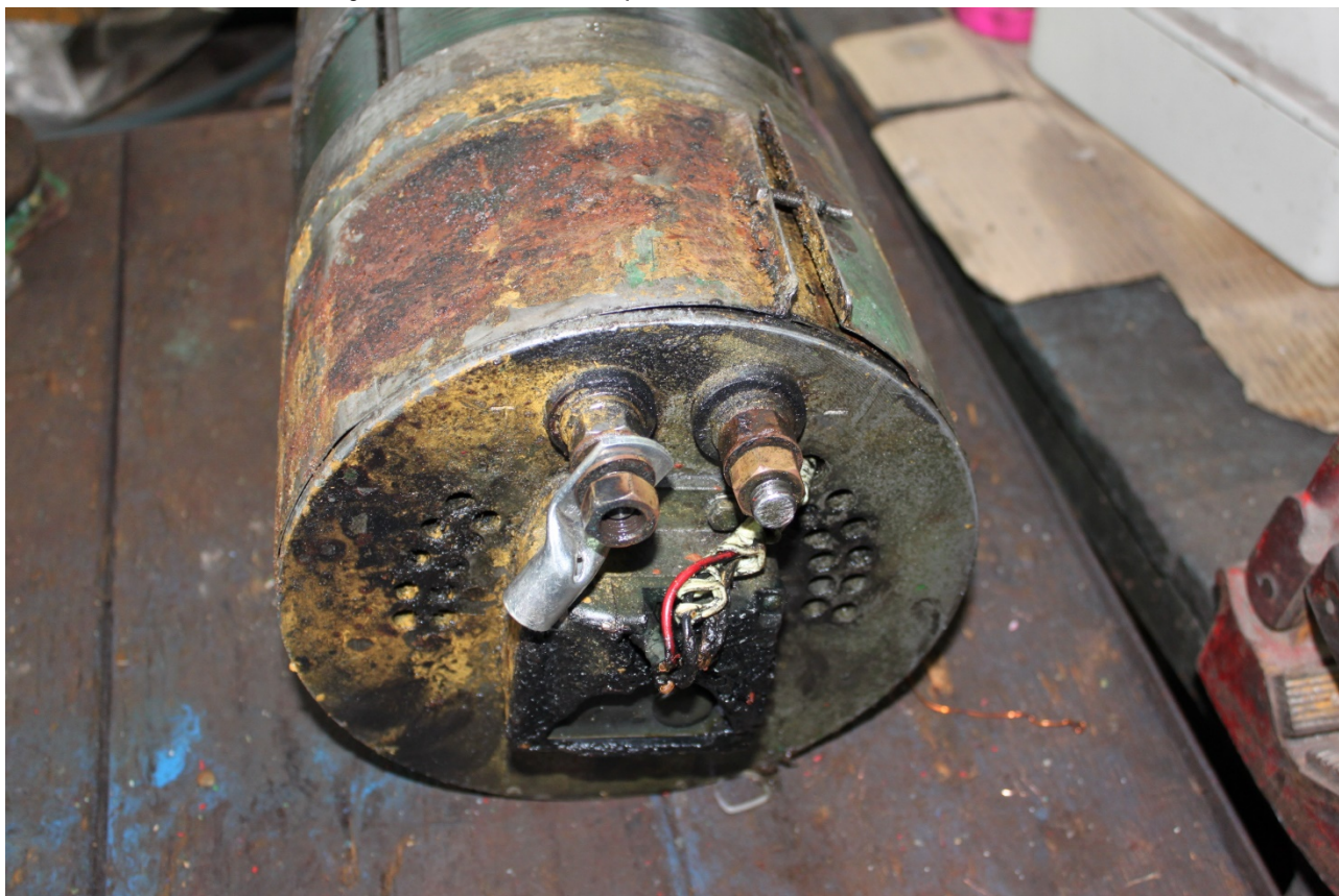
Figura 7. Dinamo instalada a bordo en el momento del accidente.
