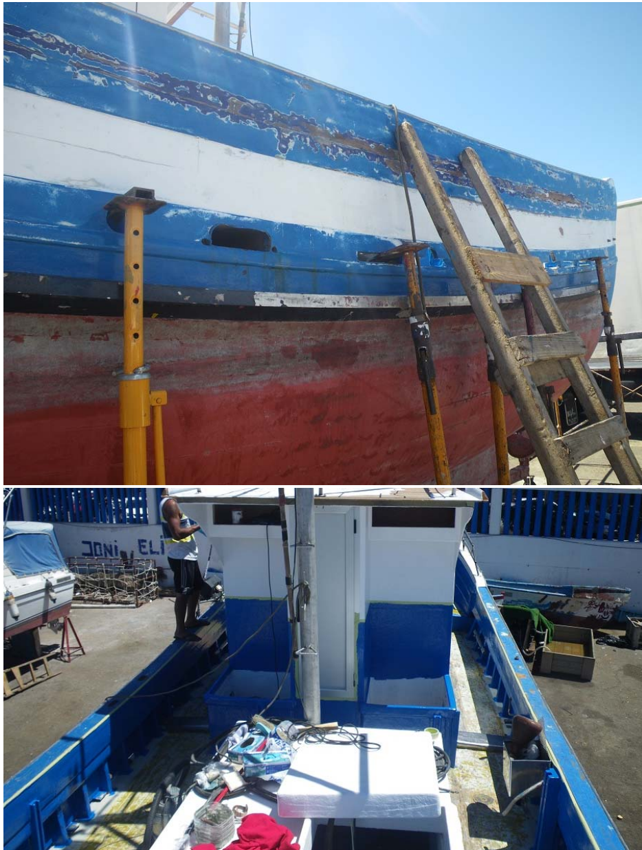
Figura 7. Prolongación vertical de la amurada mediante tablonés
